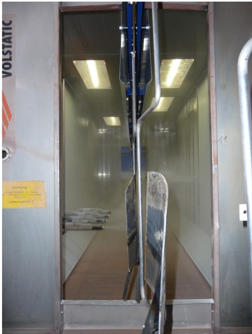
Abbildung 16: Blick in die Lackieranlage bei der Inbetriebnahme (Aufnahmedatum 04.07.12, „Nebel“ in Anlage ist Pulverlack)
