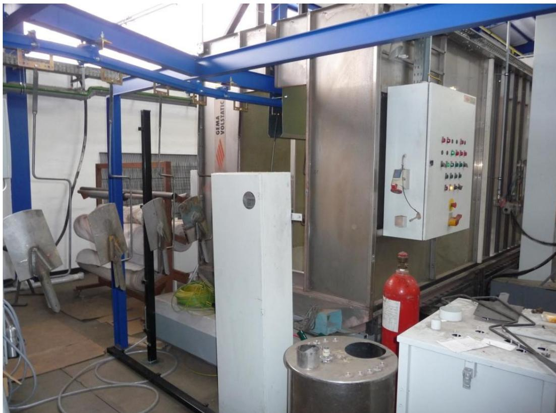
Abbildung 15: Lackieranlage mit „Probespaten“ (Aufnahmedatum 04.07.12)
