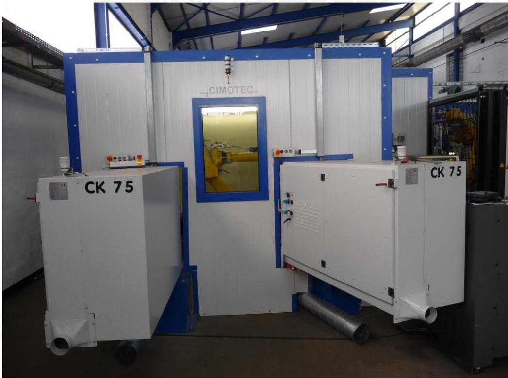
Abbildung 14: Schleifzelle von außen mit beiden Schleifbänderantrieben (Aufnahmedatum 04.07.12)
