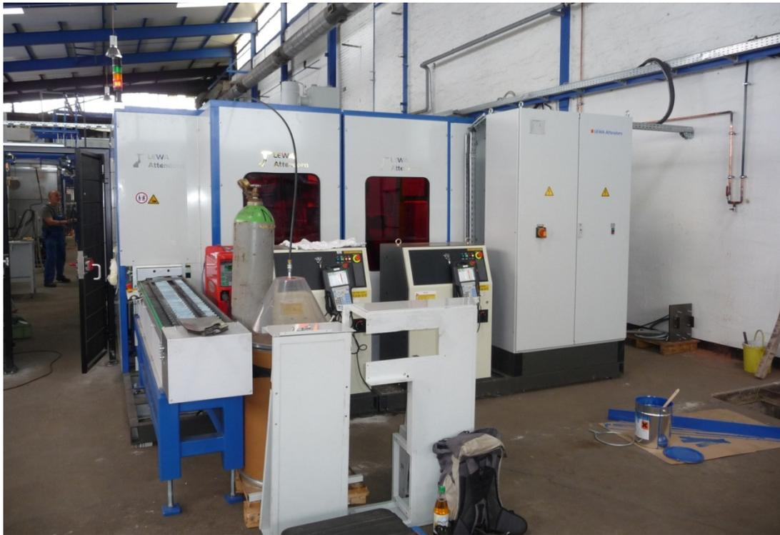
Abbildung 12: Blick auf die Bearbeitungszelle mit induktiver Erwärmung, Abschreckstation und Schweißanlage (Aufnahmedatum 04.07.12)
