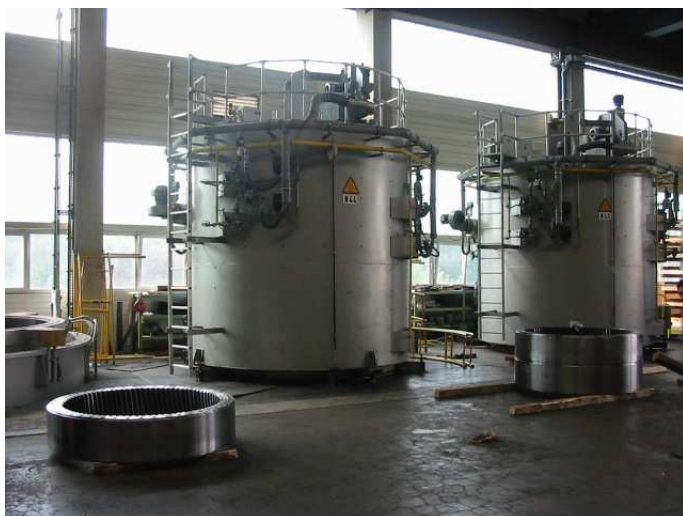
Abbildung 2: Ofenanlagen mit Getrieberädern, Härterei Carl Gommann GmbH
