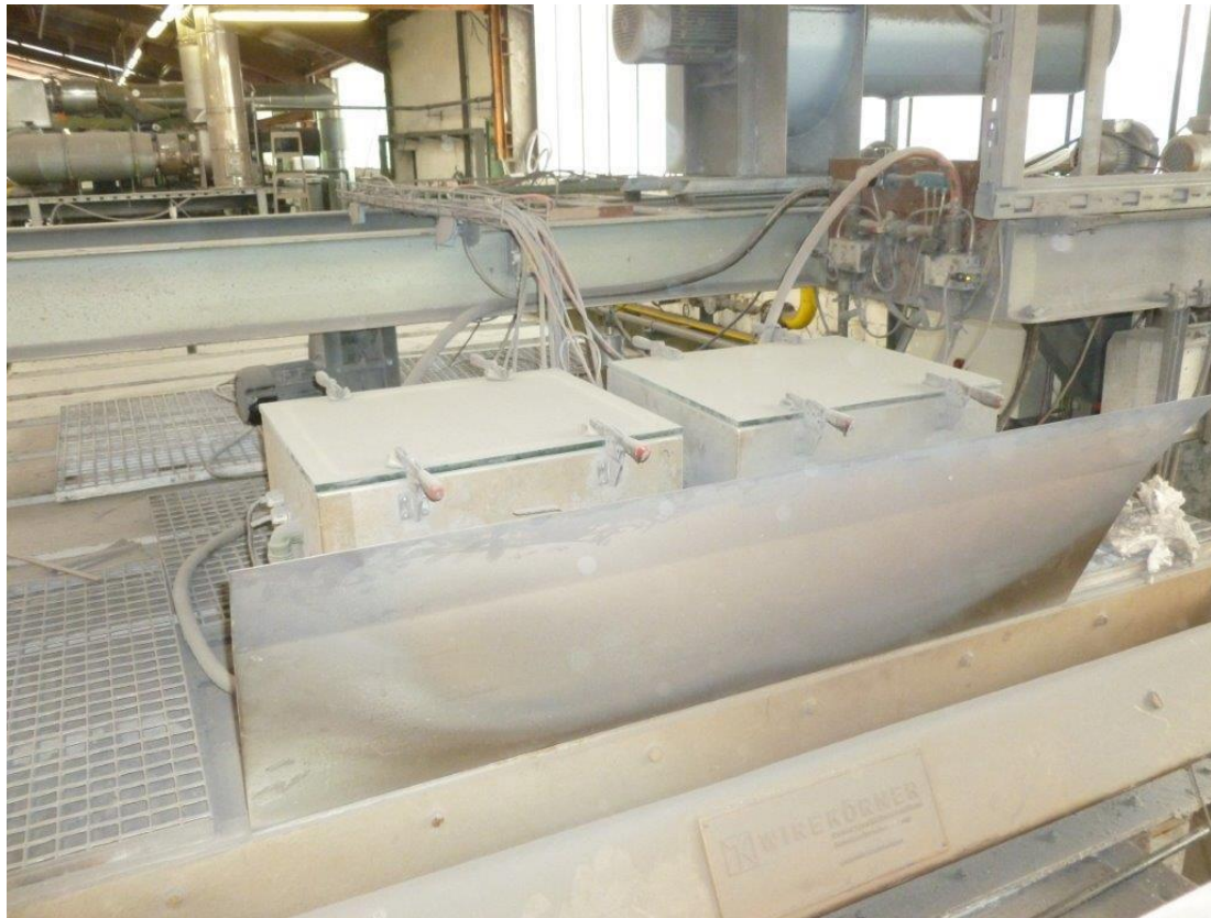
Abbildung 14: Gehäuse mit Überdruck für Wärmekamera
