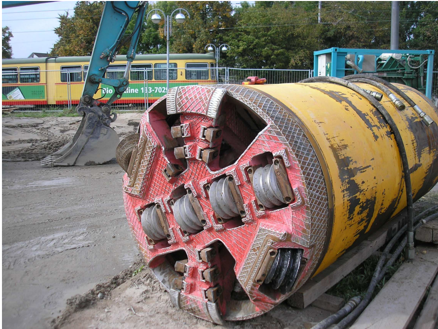
Abbildung 13: Bohrkopf für die Durchpressung
