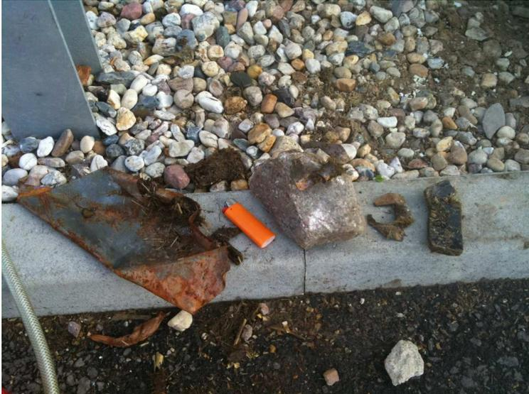
Abb. Fremdstoffe im Kugelventilhahn Substratleitung (2 Wochen blockiert!)
