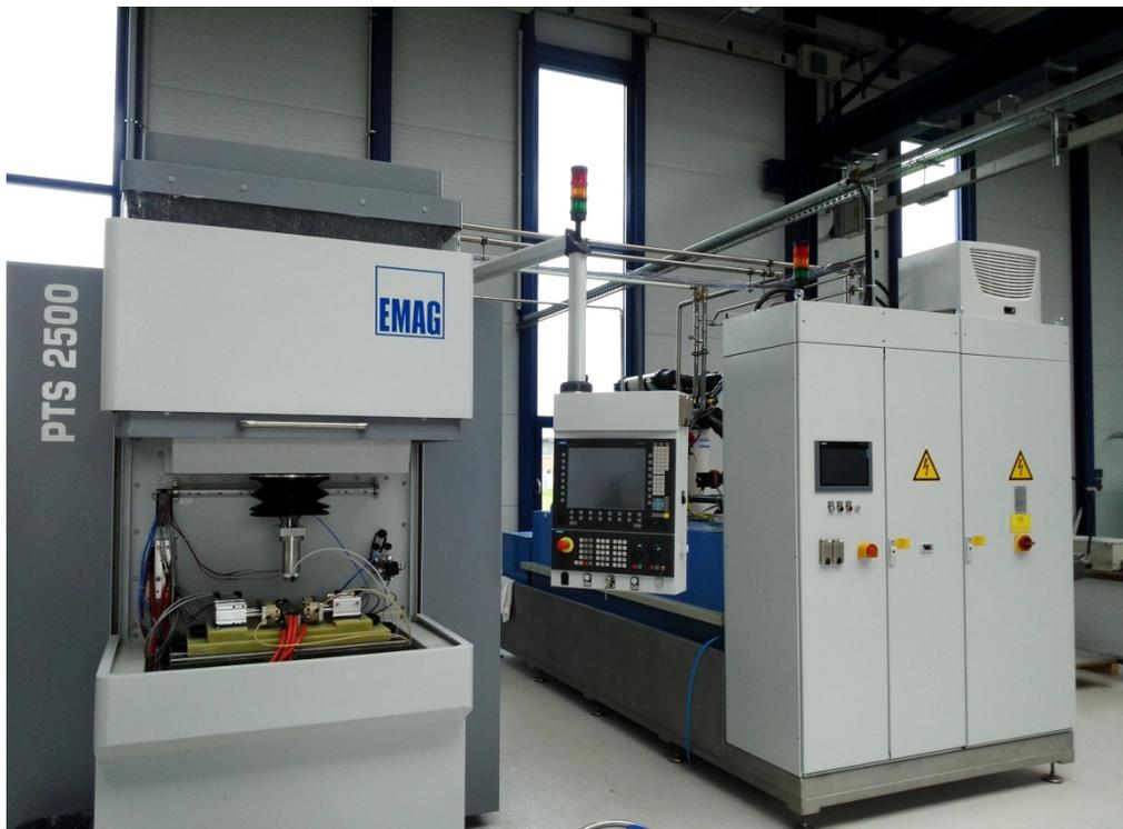
**Abbildung 5: Gesamtaufbau (Arbeitsraum mit Achsen, Kathode, Anode links und Elektrolytaufbereitung rechts)**
