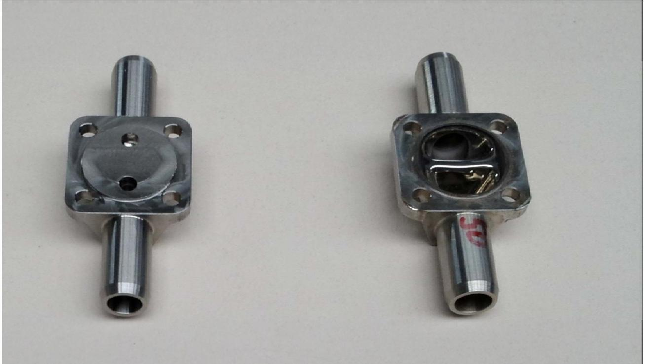
**Abbildung 11: Demonstrationsbauteil Ventilkörper eines Membranventils vor (links) und nach (rechts) der Bearbeitung**
