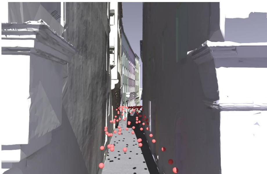
Simulation zur Berechnung der Beleuchtungsstärke (Grundlage Laserscanning)
