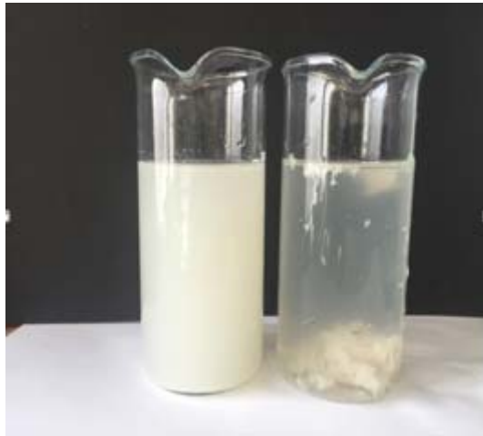
Abbildung 3: Abwasser vor und nach Flockung (Quelle ABS Steding GmbH)
