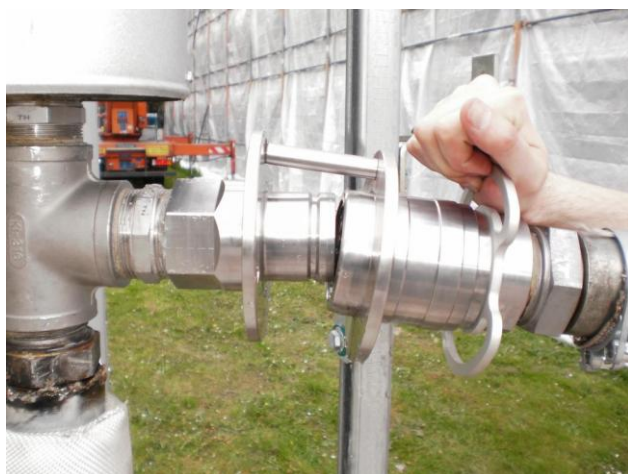
Abb.8 - Kuppeln mit den Drückkupplungen, der obere Steckbolzen ist die Kodierung für diesen Anschluss
