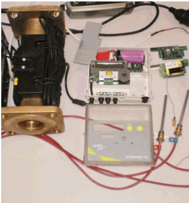
Abb. 21 - Ultraschall-Wärmemengenzähler mit Zählrohr in Flanschbauweise, geöffnetem Rechenwerk und den Temperaturfühlern
