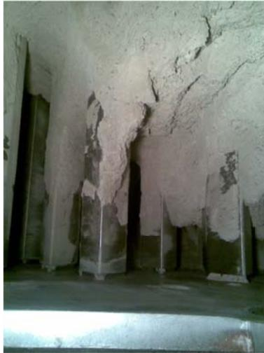
Bild 2: Verstopfungen im Gemengevorwärmer, Blick von oben
