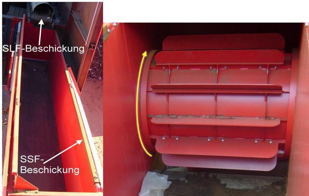
**Abbildung 2: Befüllungsarten des Bunkers (links) und Dosiertrommel (rechts)**
