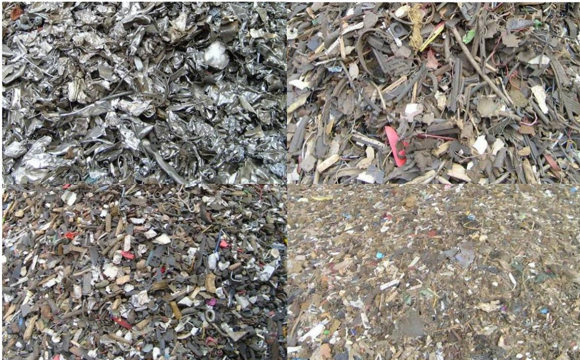
**Abbildung 9: Outputfraktionen der Behandlung von Schredderschwerfraktion in der Kompaktortieranlage: Metallfraktion (o.li.), Nichtmetallfraktion (o.re.), Siebunterkorn < 40mm (u.li.), Windsichterleichtfraktion (u.re.)**
