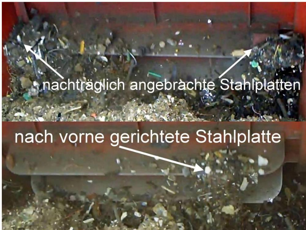
**Abbildung 3: Nachträglich angebrachte Stahlplatten**
