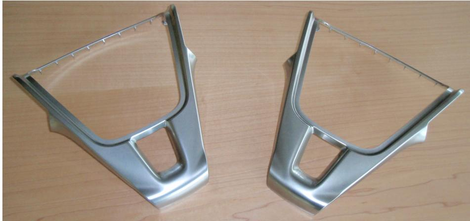
Abbildung 27: Vergleich galvanisch erzeugte Lenkradzierblende für die Automarke Volvo links und über innovatives Lacksystem erzeugte Blende rechts
