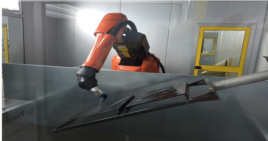
Abbildung 22: Lackierroboter (Foto vom 12.02.2015)
