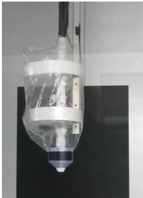
Abbildung 16: Auffangbehälter Trockeneisdüse (Foto vom 07.09.2015)
