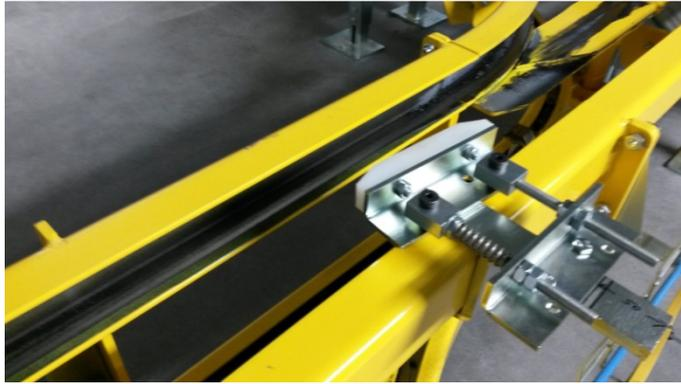
Abbildung 20: Bremse um den Wagen in Position zu halten (Foto vom 07.09.2015)
