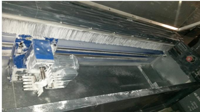
Abbildung 19: Mobiles Bürstenreinigungsgerät zum einmaligen Abreinigen der Bürsten in ausgebautem Zustand (Foto vom 07.09.2015)
