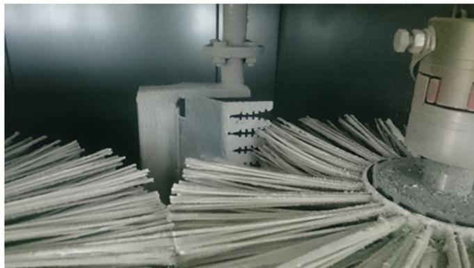
Abbildung 18: Eintauchtiefe der Abrakelvorrichtung in die Bürsten (Foto vom 07.09.2015)
