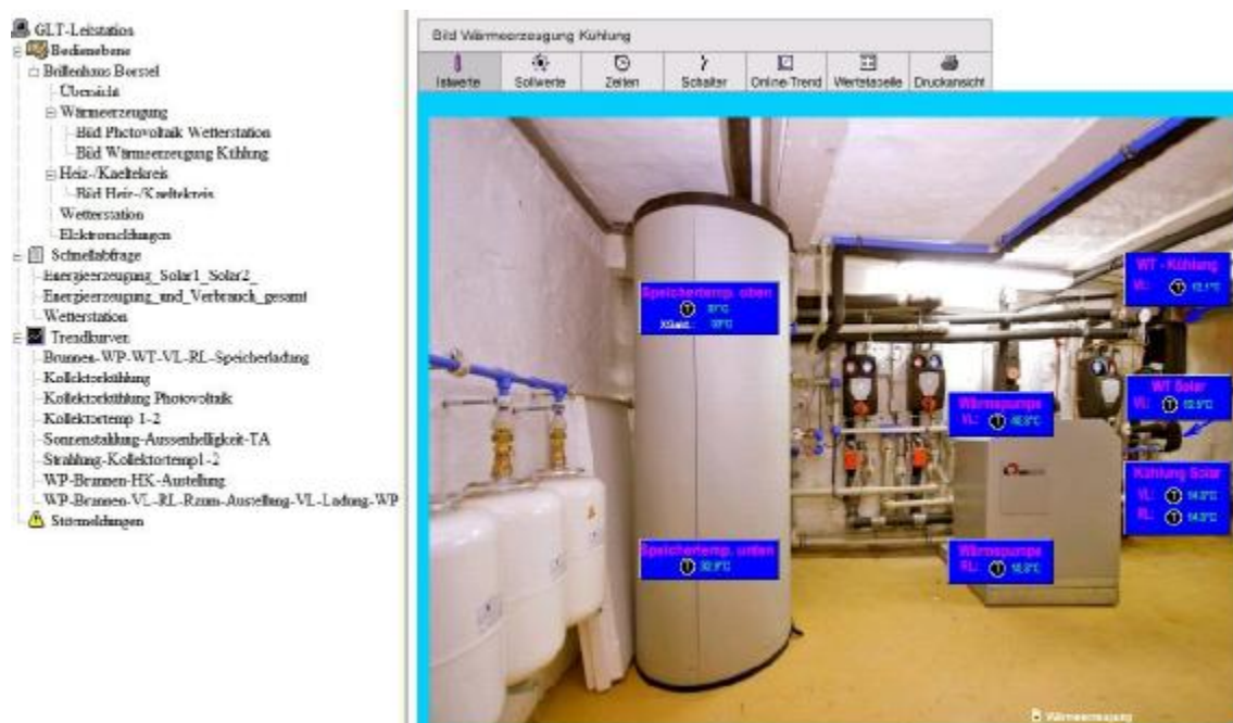
Technikraum mit Messpunkten
