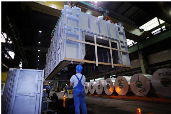
Abbildung 14: „Einbringen des Ofenoberteils durch das Warmwalzwerk“
