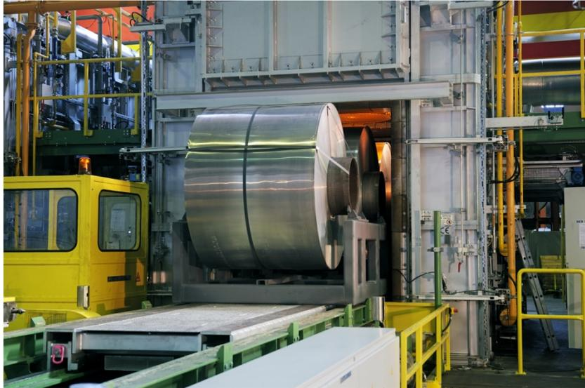
Abbildung 19: „Beladen eines Ofens bei Inbetriebnahme“
