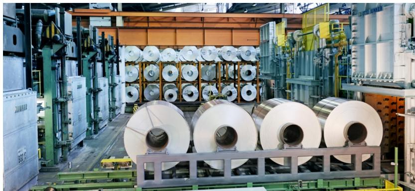
Abbildung 18: „Chargierwagen beladen mit Coils bei Inbetriebnahme“
