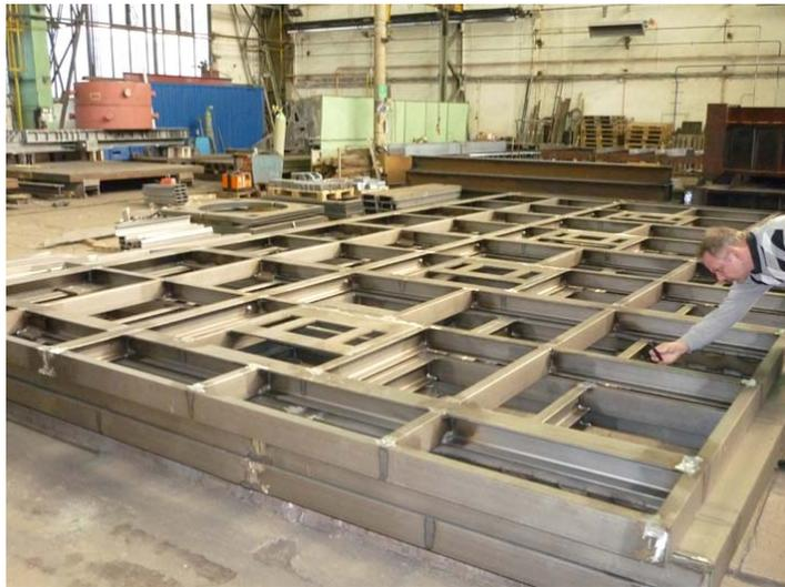
Abbildung 10: „Grundrahmen eines Ofen wird vermessen“
