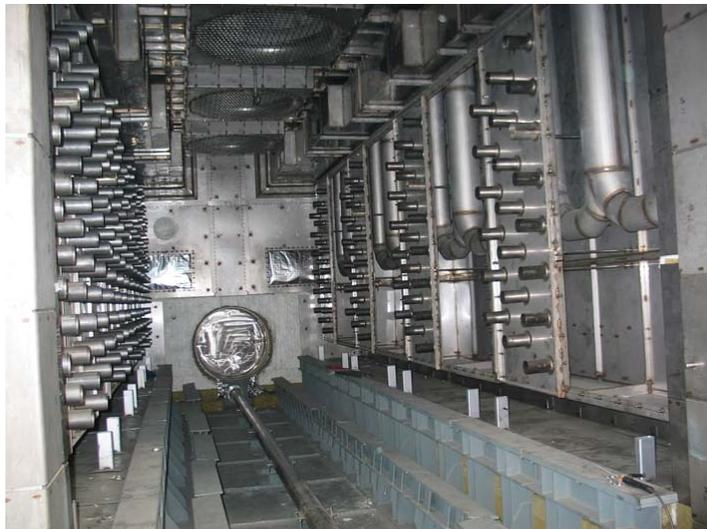
Abbildung 11: „Ofeninnenraum mit teilweise montierten Düsenwänden“
