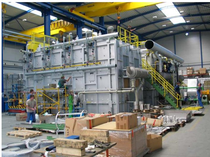
Abbildung 12: „Komplett vormontierter Ofen“
