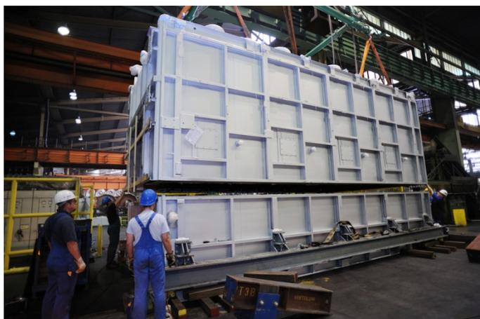
Abbildung 15: „Aufsetzen Ofenoberteil auf Ofenunterteil“
