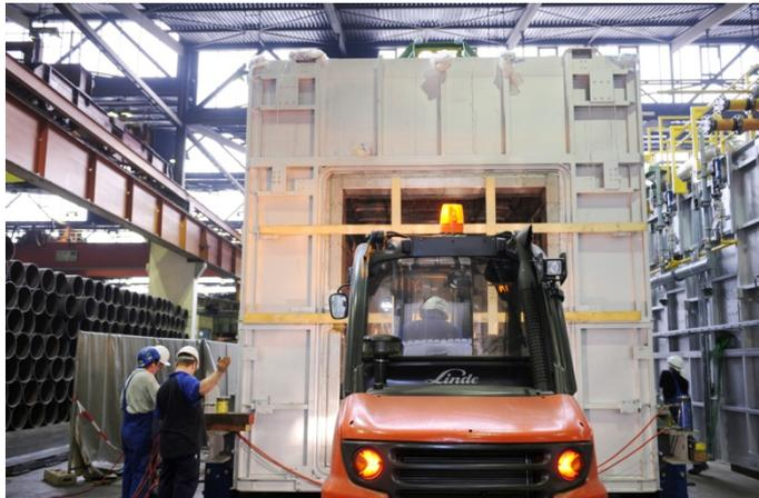
Abbildung 17: „Verschieben eines montierten Ofens an den endgültigen Standort“
