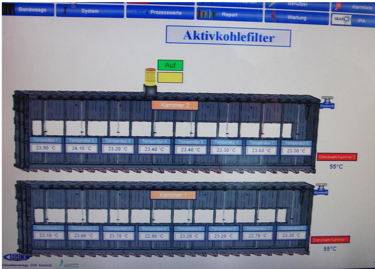
Abbildung10: AK Filter mit Temperaturüberwachung und Löscheinrichtung
