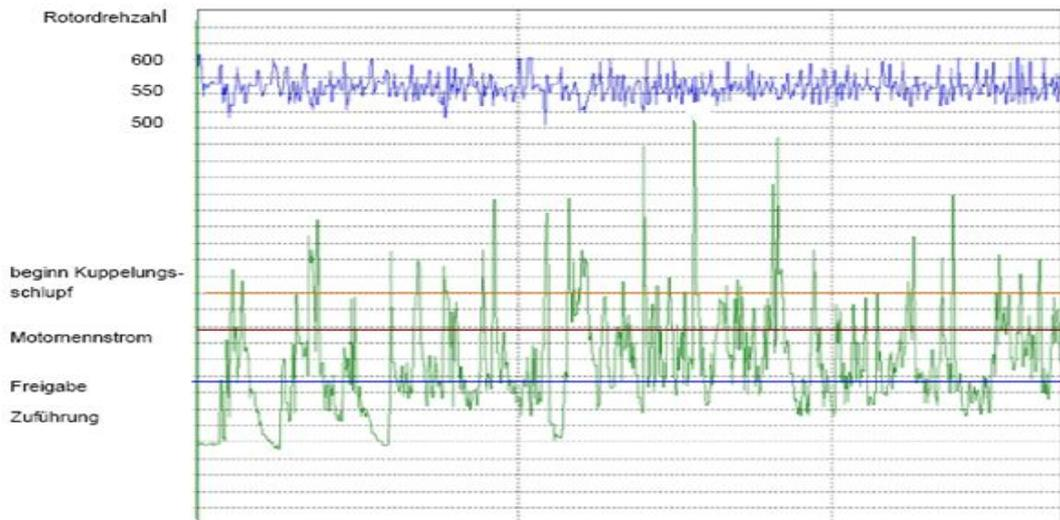
Abbildung 2: Motorbelastung bei diskontinuierlichem Betrieb
