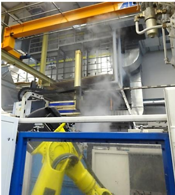
Abbildung 6 Beim Gießprozess aufsteigende Emissionen
