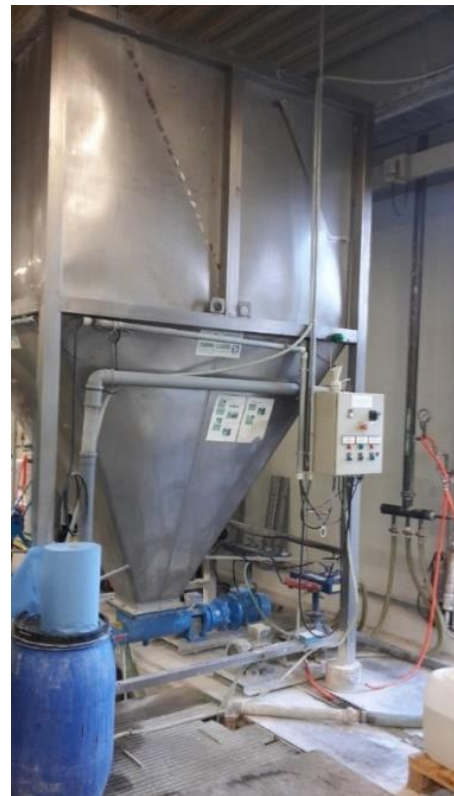
Alter Sedimentator mit Flockungsmittel s. u. schematische Darstellung
