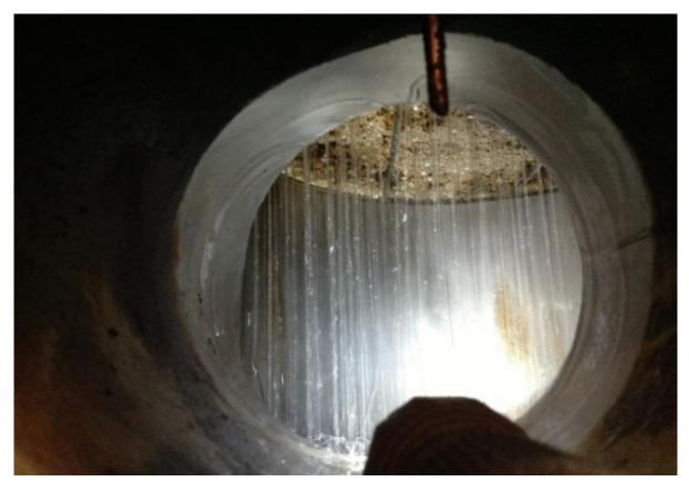
Abbildung 8: Wasserverteilung unterhalb des untersten Pads bei Pumpendrehzahl 40 Hz
