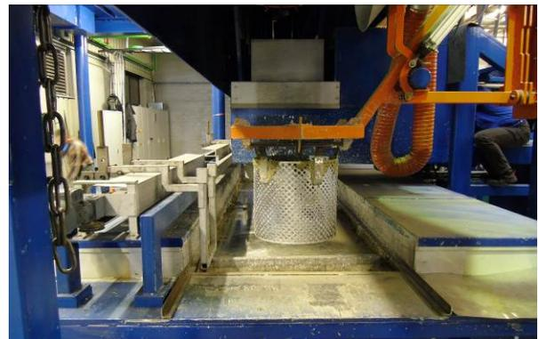
Abb. 13: Zentrifuge mit Schleuderkorb
