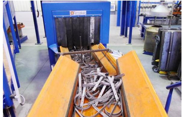
Abb. 15: Vibrationsfördersystem und Trockenofen
