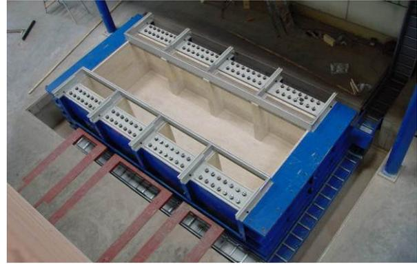
Abb. 11: Keramisch ausgekleideter Verzinkungssofen
