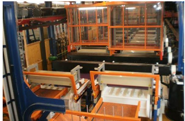
Abb. 9: Füllstation der Trommelaggregate
