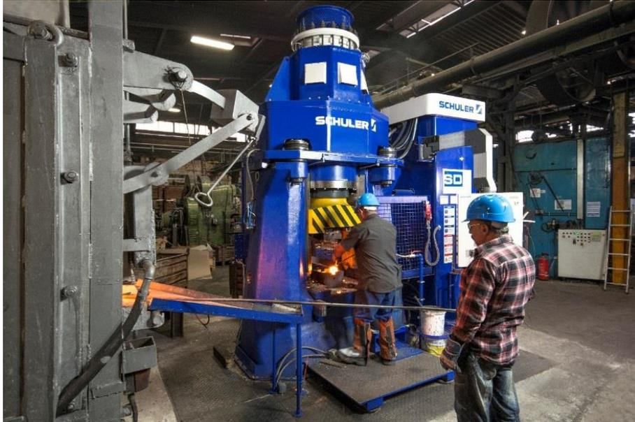
Bild 8: Linearhammer im Testbetrieb
