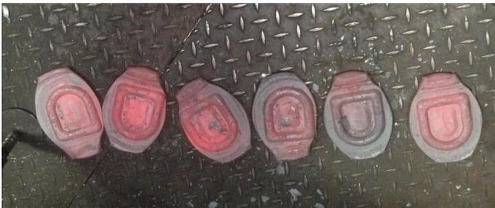
Bild 17: Schmiedeteile aus der Versuchsreihe
