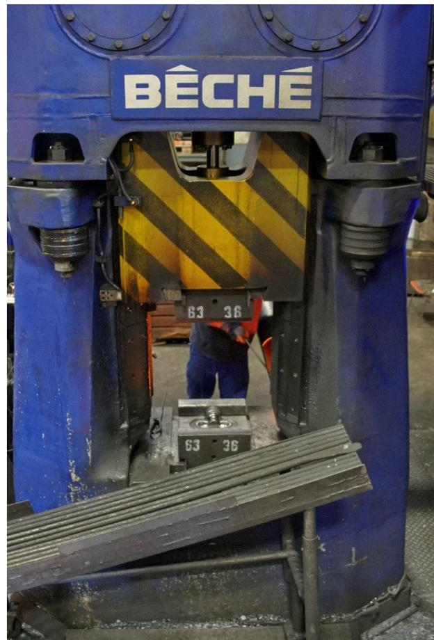
Bild 2/3: konventionelle Schmiedehämmer mit Hydraulikantrieb
