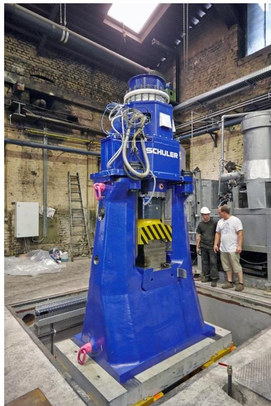
Bild 13/14: Aufstellung des neuen Linearhammers
