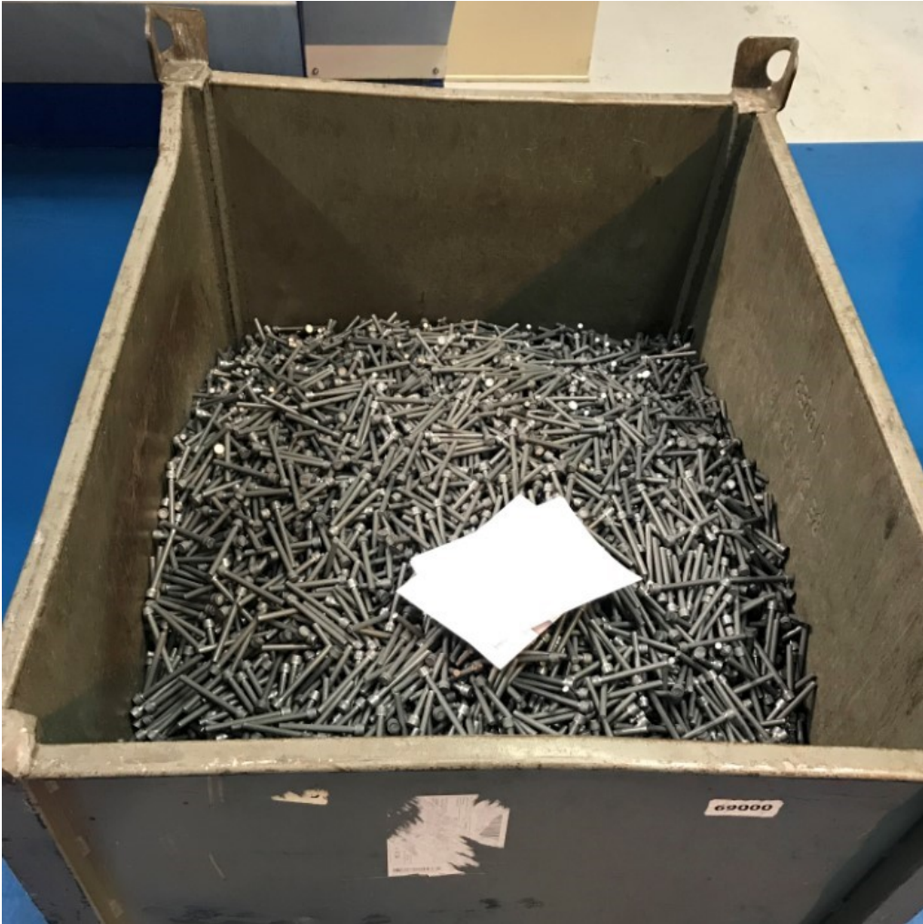
Abbildung 6 Rohlinge nach Kaltumformung mit
