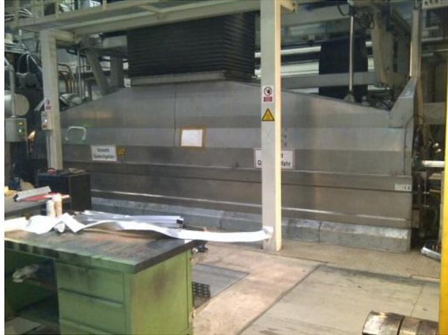
Abbildung 4: Kühltunnel an der GIA-Strangpresse (integrierte Luft- und Wasserkühlung)
