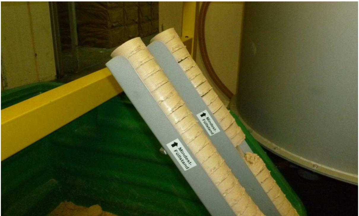
Abbildung 40 Brikettpressenauslauf mit Briketts
