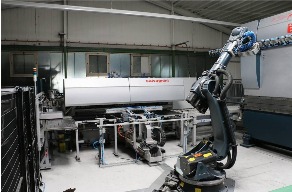
Abbildung 12: Im Hintergrund das Biegezentrum und vorne der Handlingsroboter, Aufnahme vom 14.07.2014
