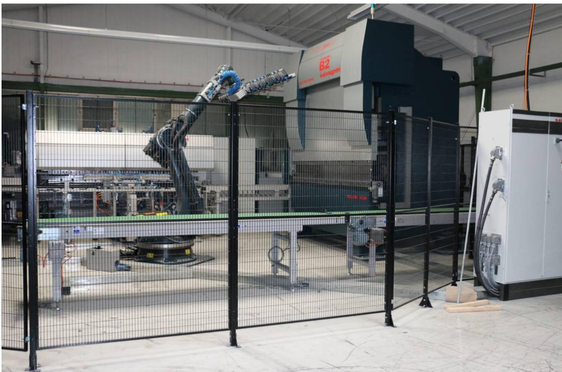
Abbildung 14: Rechts die Abkantpresse und mittig der Handlingsroboter, Aufnahme vom 14.07.2014
