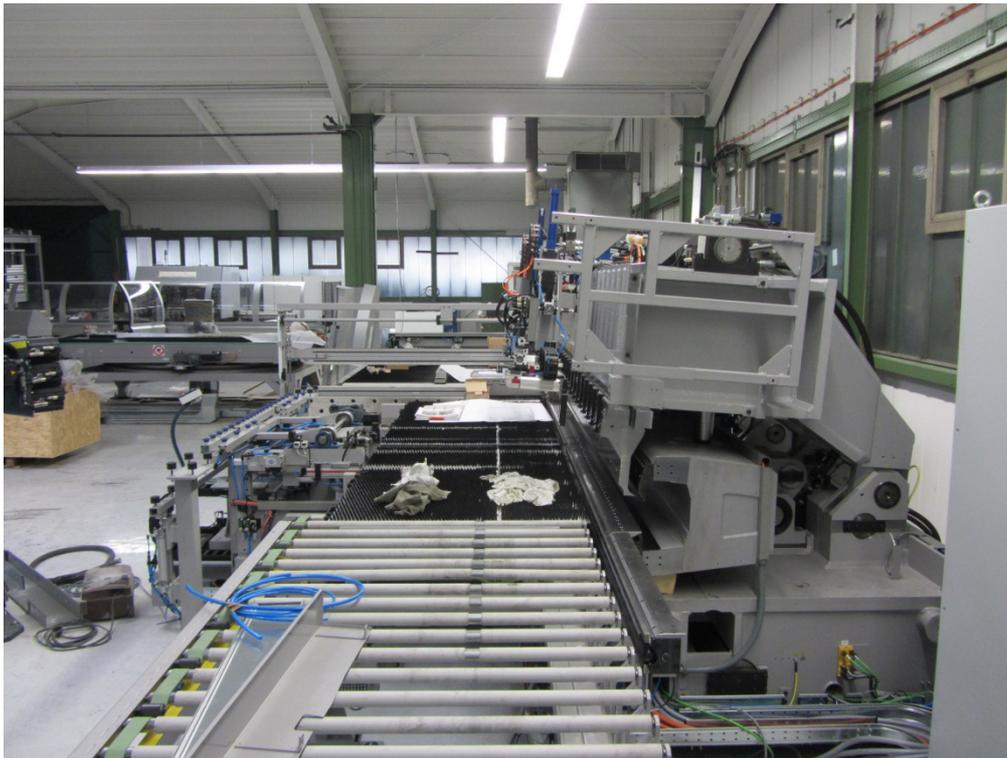
Abbildung 23: Montage Transportband und Biegemaschine, Aufnahme vom 15.04.2013
