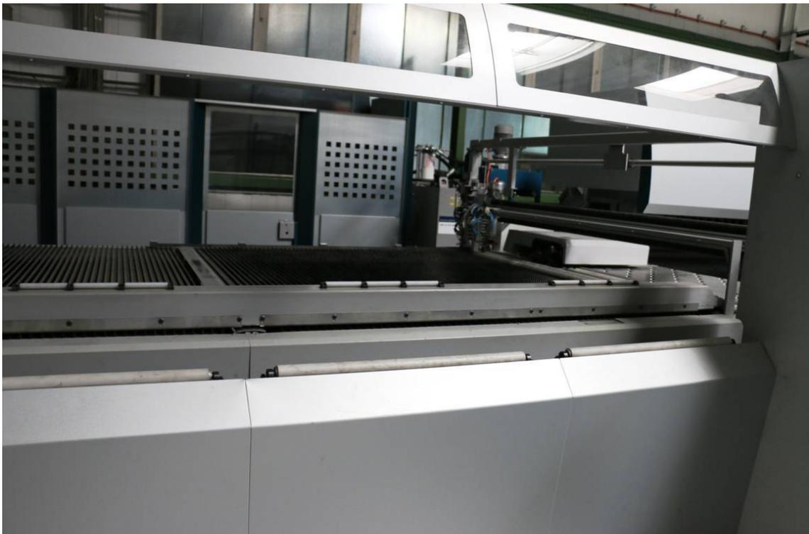
Abbildung 11: Transport und Zentriervorrichtung mit Bürstenstation, Aufnahme vom 14.07.2014
