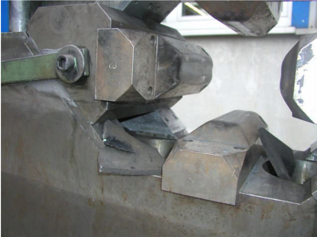
Abbildung 7: selbst entwickeltes 4-Backen-Werkzeug
