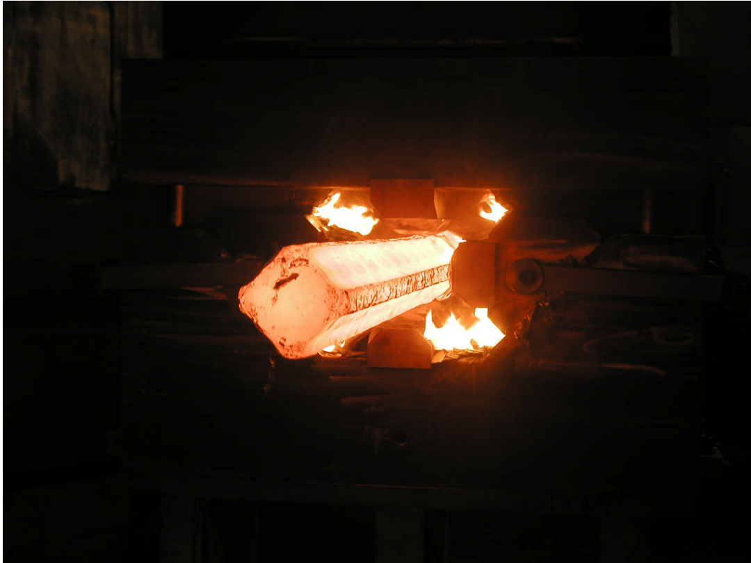
Abbildung 1: Schmiedepresse mit neuartigem 4-Backen-Werkzeug
