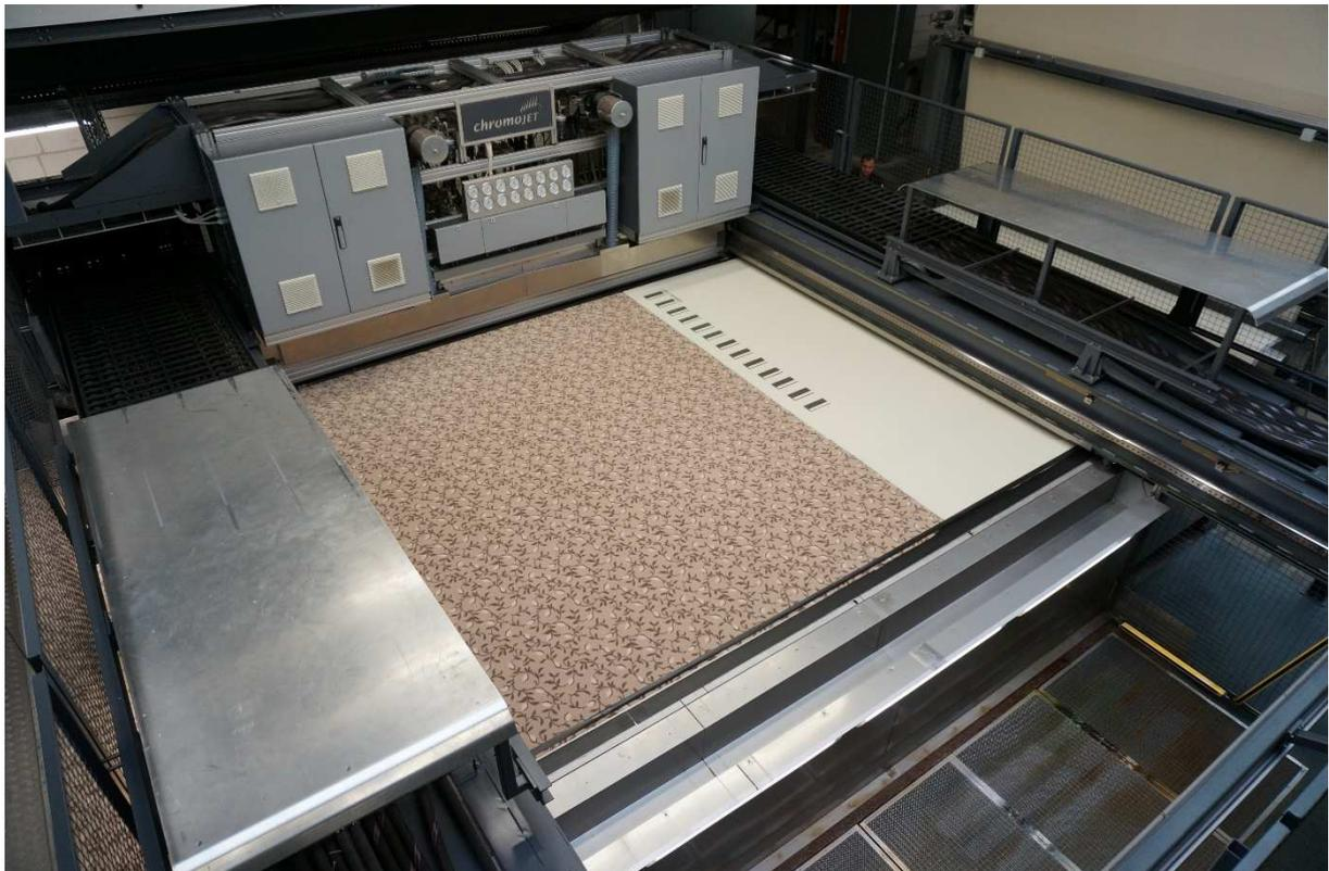
Abbildung 2: Blick von oben auf den Druckkopf der bisherige Anlage
