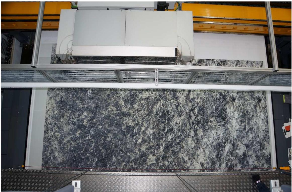
Abbildung 20: Druck eines Steinmusters (Blick auf Druckkopf)
