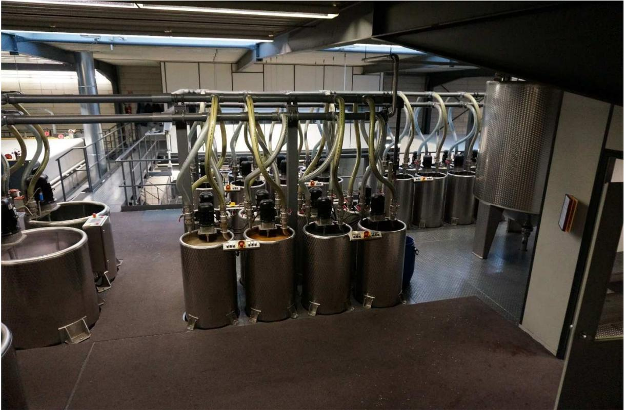
Abbildung 5: Farbvorratsbehälter der alten Anlage
