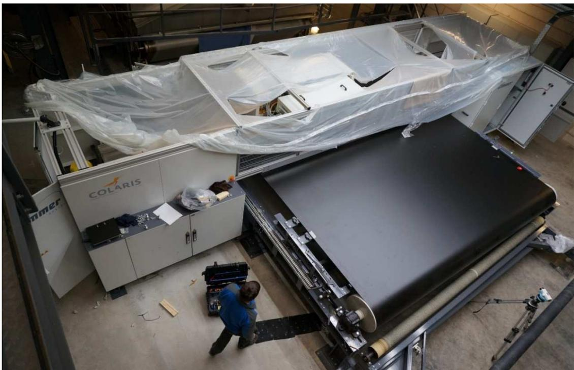
Abbildung 10: Blick von oben auf die Druckkopfführung mit montiertem Drucktisch
