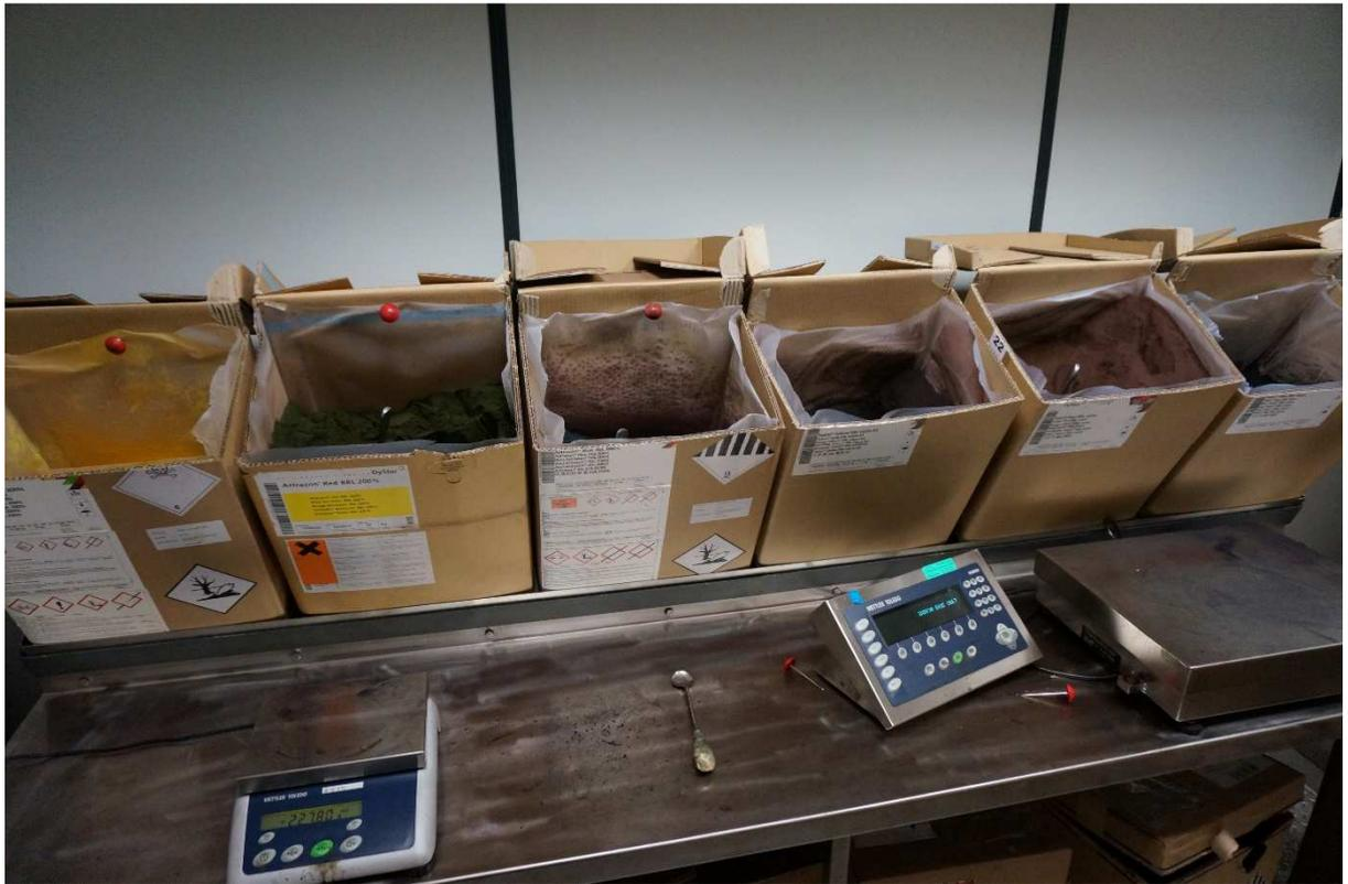
Abbildung 3: Farbpigmente und Waagen zur Mengendosierung der Pigmente für den Farbansatz
