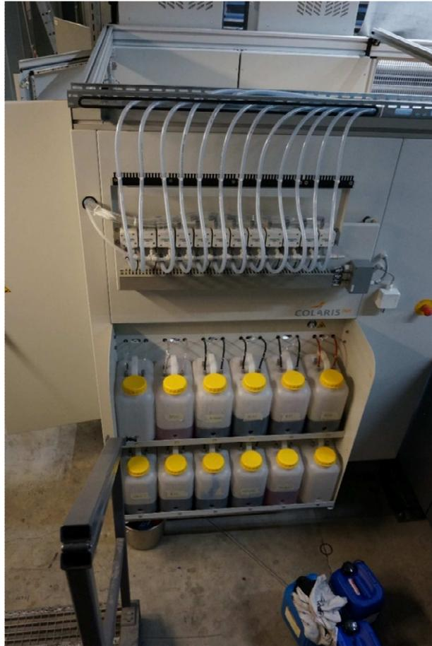
Abbildung 11: Farbvorratsbehälter mit gesamter Farbfüllung der neuen Teppichdruckanlage
