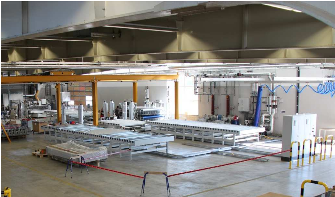
Abbildung 12: Montage der Kabelkanäle, Schaltschränke, Rollenbahnen und Pressetagen
