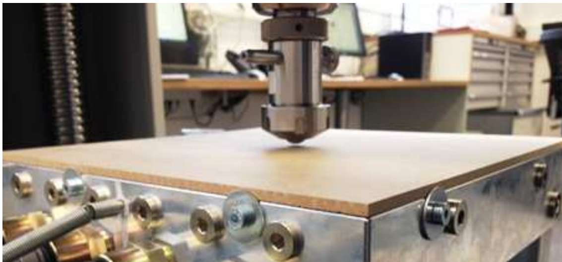
Abbildung 25: Prüfvorrichtung für einen Klebstoffzugfestigkeitsversuch
