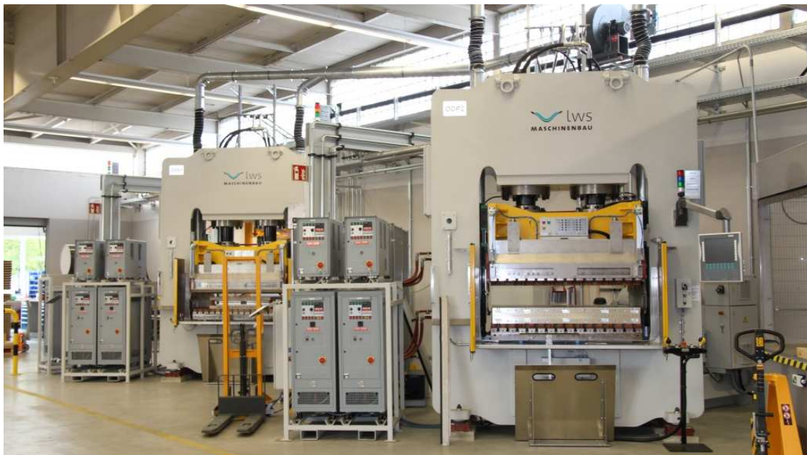
Abbildung 11: Ansicht auf zwei von vier Hochdruckpressen mit eingebauten Werkzeugen
