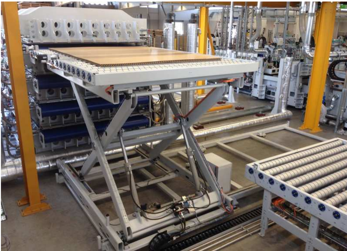
Abbildung 17: Probetrieb des Scherenhubtisches
