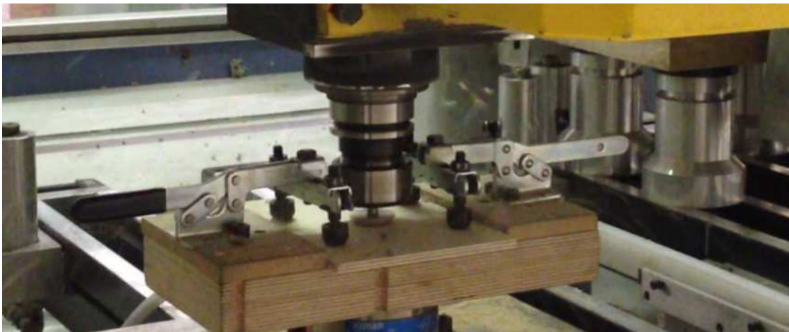
Abbildung 26: Bohrversuch zur Ermittlung der Schnittkräfte am IfW in Stuttgart
