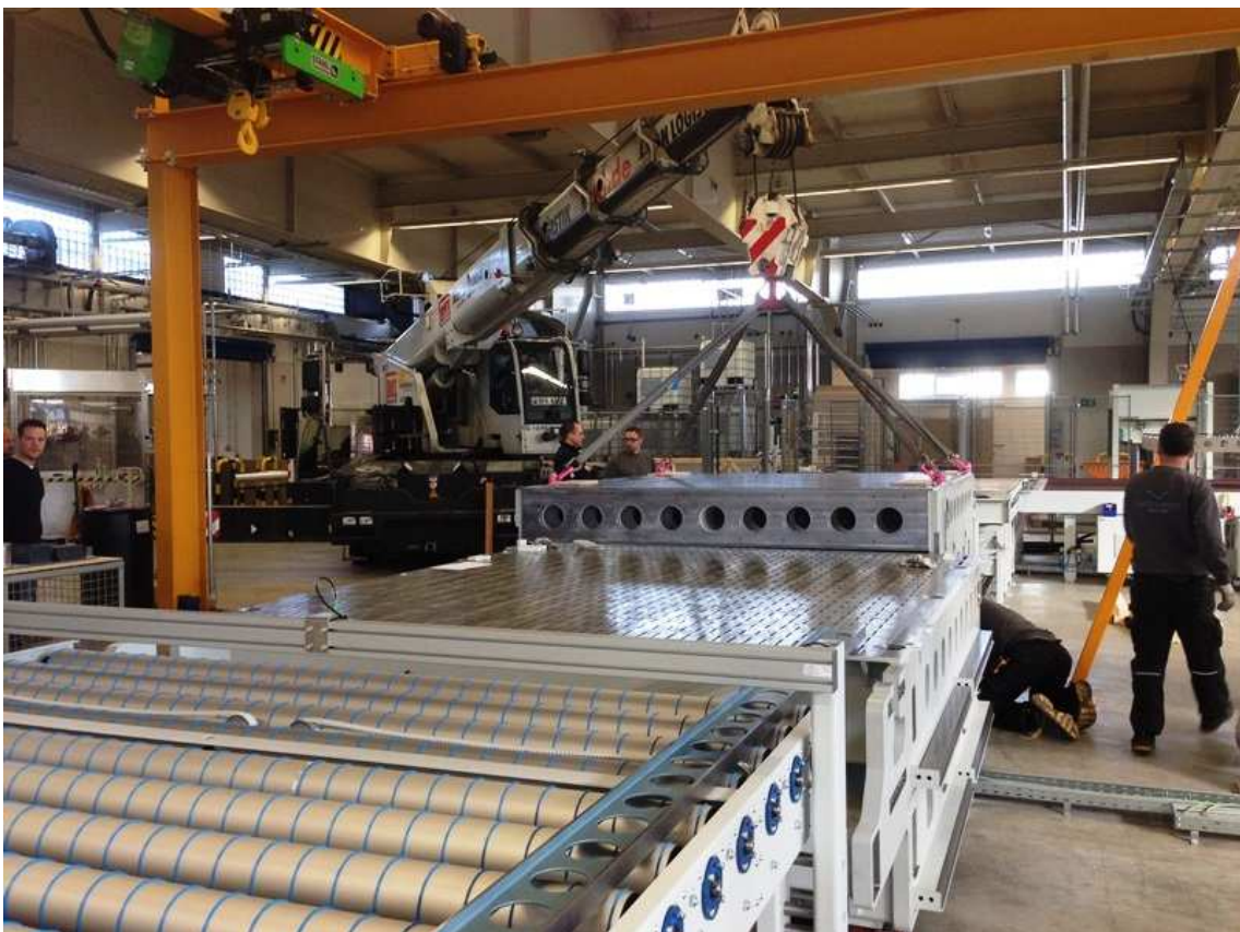
Abbildung 16: Montage des zweiten Maschinengestells des Bohr- und Beleimautomaten
