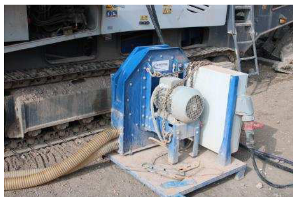
Bild 5: Schlitzdüse zum Ausblasen der Leichtstoffe und Gebläse für die Sichtluftzufuhr
