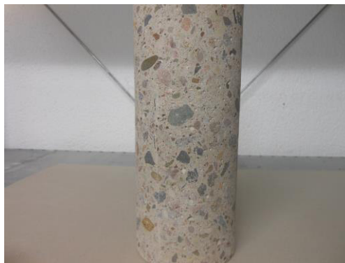
V1 - C 20/25 Bohrkern
