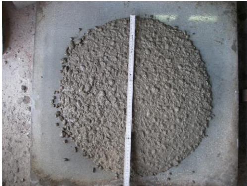
V1 - C 20/25 Frischbeton
