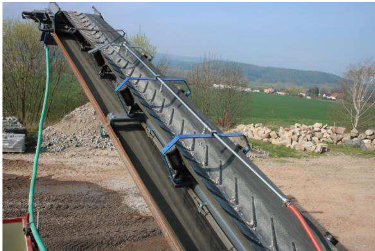
Bild 7: Vorrichtungen zur Wasserbedüsung der fraktionierten Produkte
