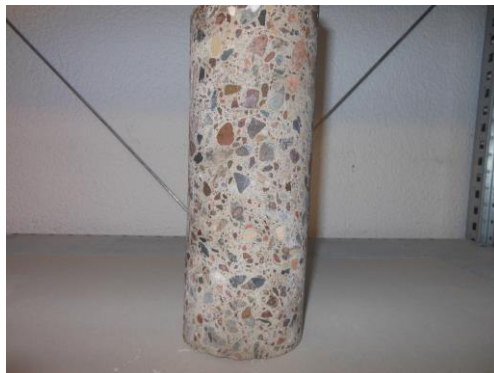
V2 - C 30/37 Bohrkern
