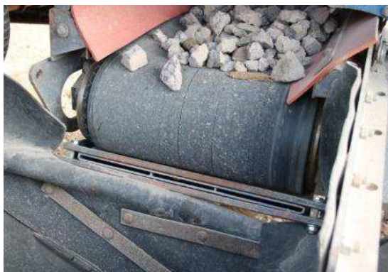
Bild 5: Schlitzdüse zum Ausblasen der Leichtstoffe und Gebläse für die Sichtluftzufuhr
