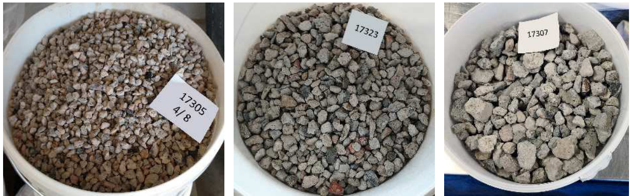
Bild 12: Fraktionen aus der Produktsiebung 4/8 mm (links), 8/16 mm (Mitte) jeweils nach der Wäsche und Windsichtung und 8/16 mm nach der Windsichtung (rechts)
