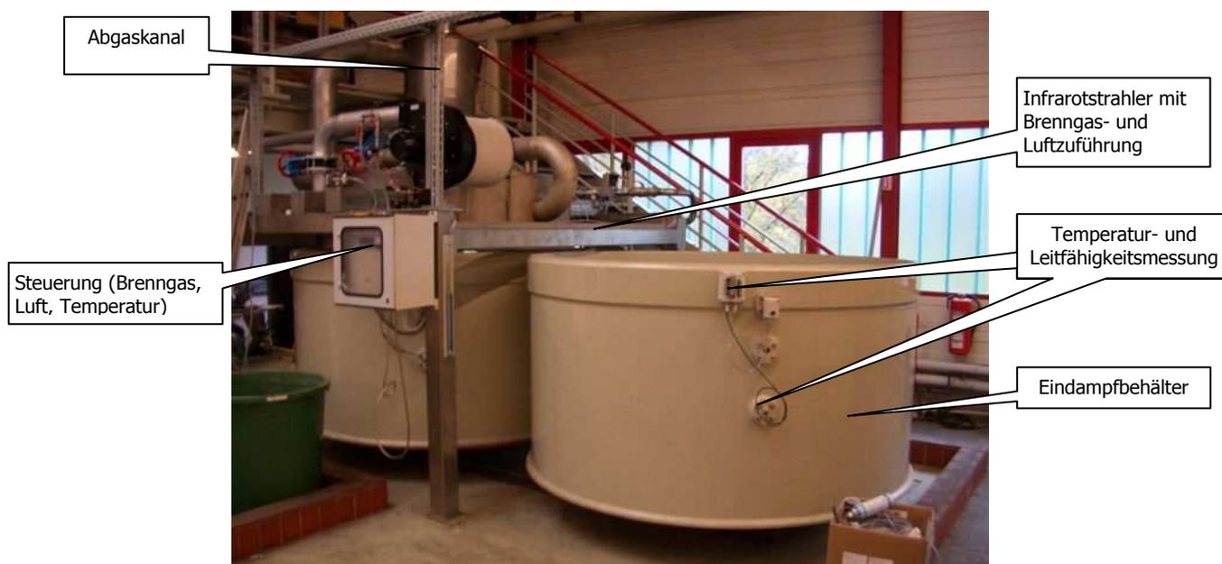
**Abb. 9: Verdampfereinheit der Fa. Schilling GmbH bei der Fa. EJOT (Foto: ABAG-itm)**
