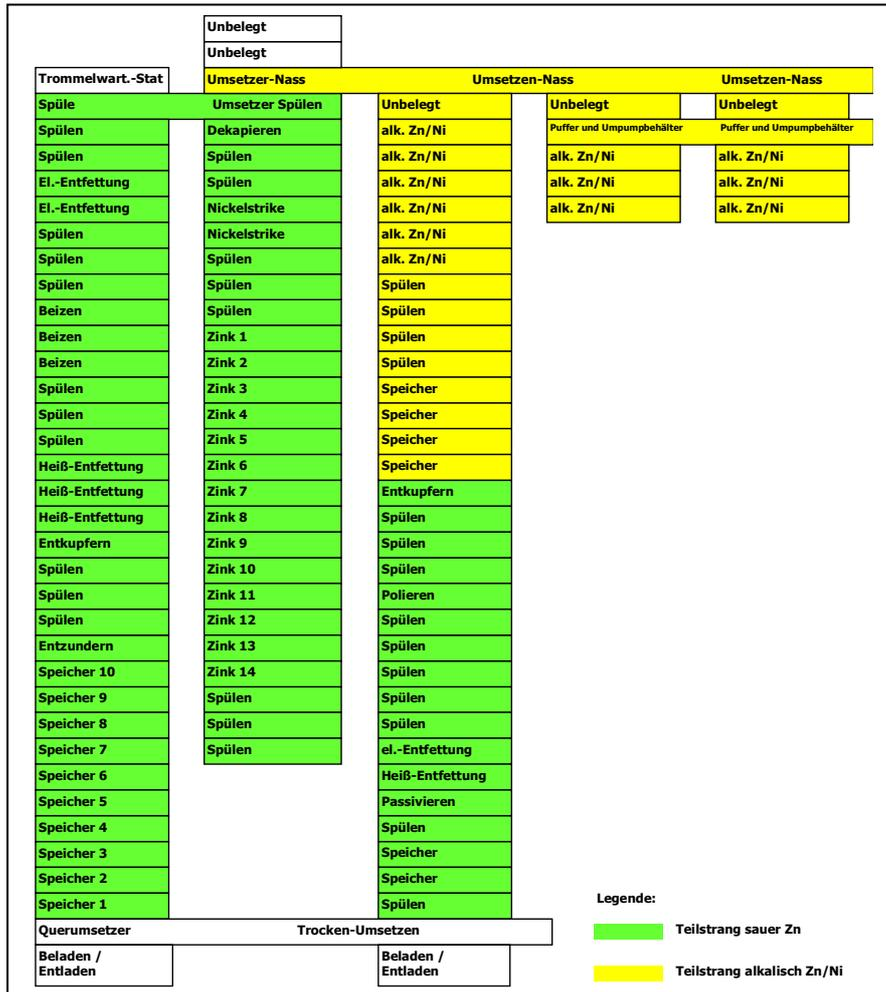
Abb. 4: Schema der galvanotechnischen Gesamtanlage mit den Teilsträngen Sauer-Zink (alt) und alkalisch Zn/Ni (neu)
