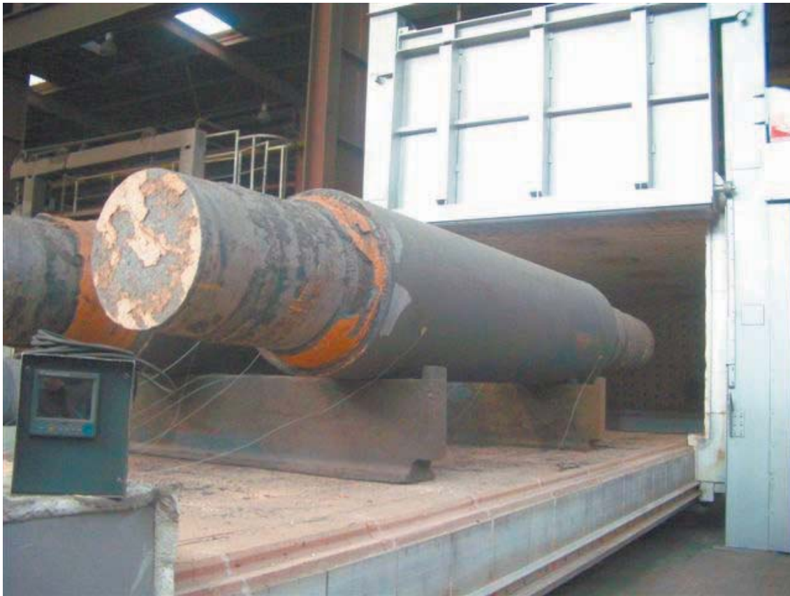
Abbildung 3: Mit Thermoelementen versehene Walzen zur kontinuierlichen Messung der Oberflächentemperatur des Glühguts während der Ofenreise
