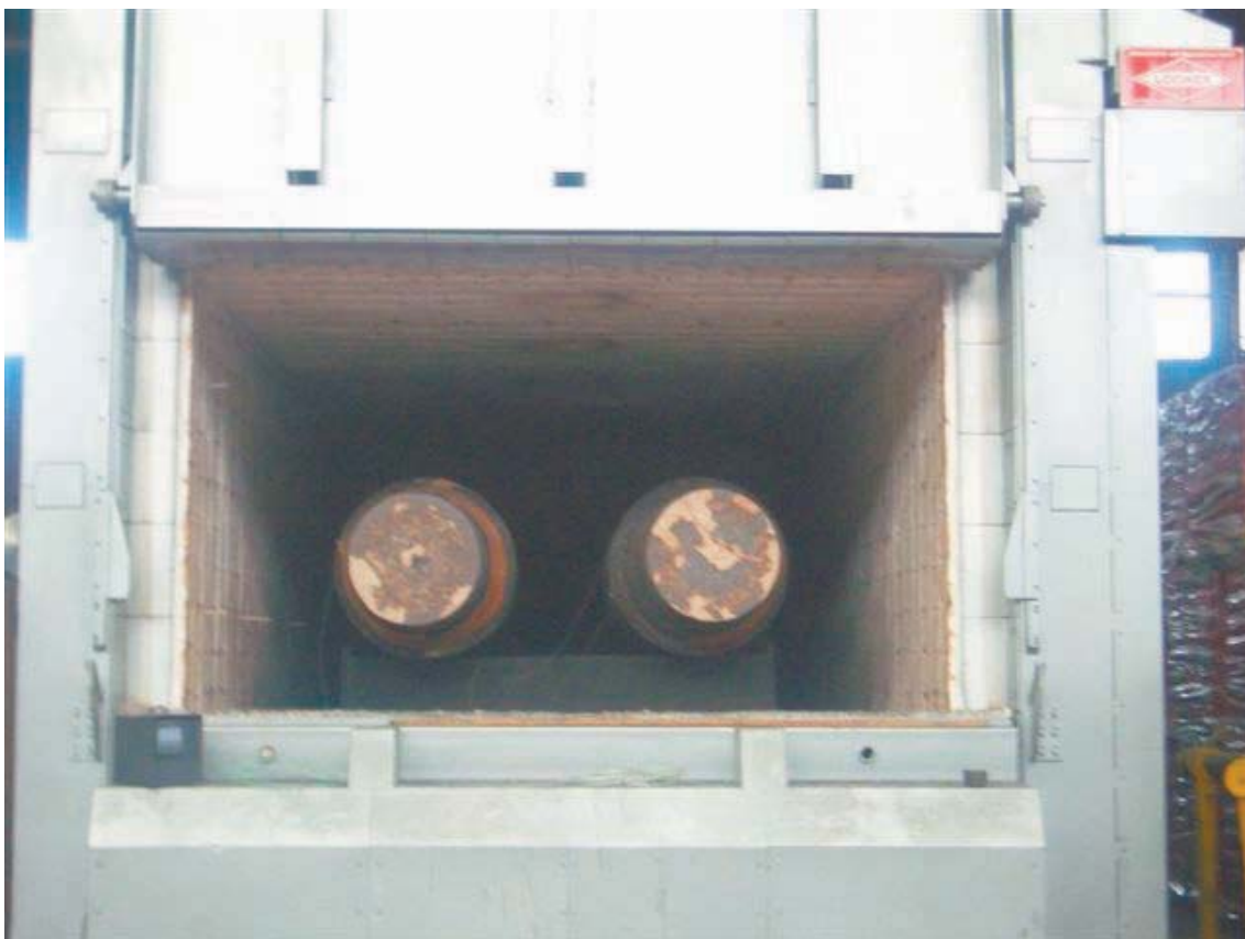
Abbildung 13: Glühgut mit Thermoelementen vor der Wärmebehandlung im temperaturstabilen Glühofen
