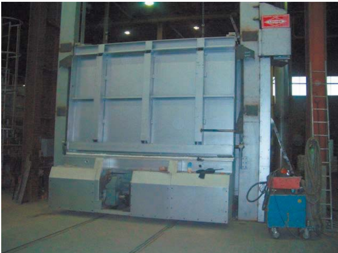
Abbildung 16: Ofenfront beim Betrieb des Glühofens (Ofentür geschossen)
