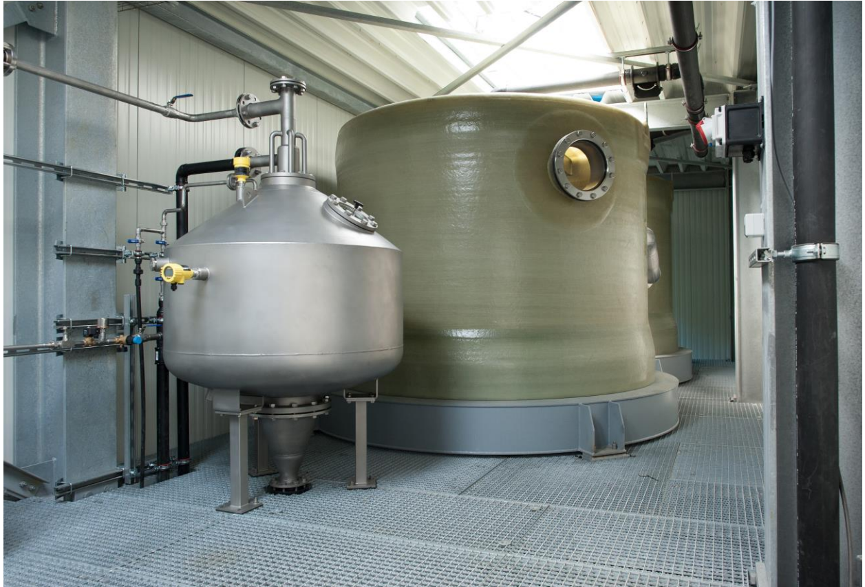
Abbildung 30: EloPhos®-Reaktor mit Vakuum-Entgasung
