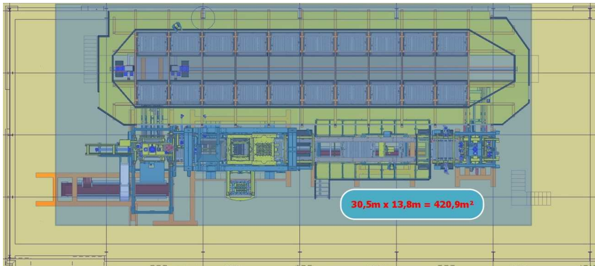
Abbildung 36: Layout der Neuanlage (Gießbereich)
