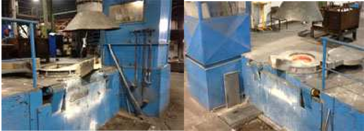
Abbildung 4: Induktionsöfen links: kleiner Ofen, rechts: großer Ofen
