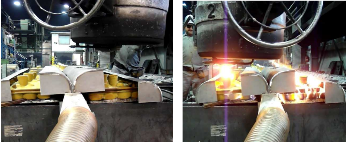
Abbildung 25: Absaugversuche mittels seitlich angebrachter Absaugleisten; das rechte Bild zeigt die erreichte Absaugwirkung während des Gießens im Vergleich zur nicht betriebenen Anlage (linkes Bild).
