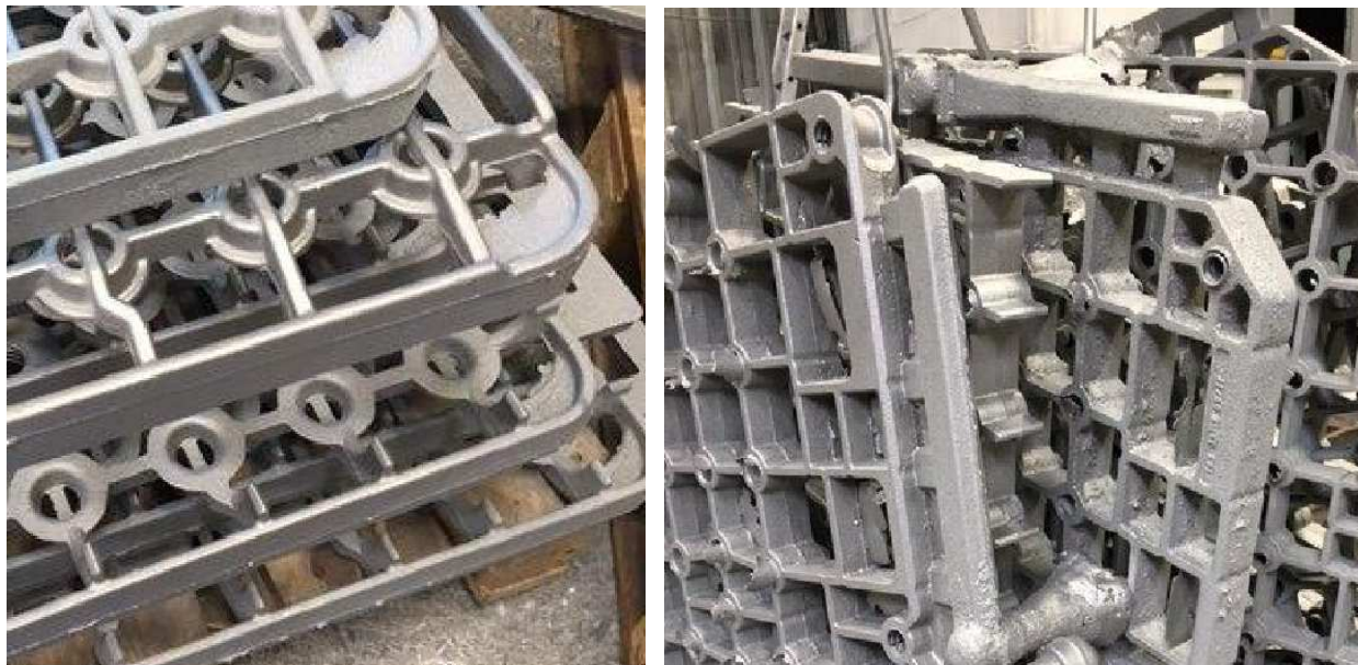
Abbildung 31: Oberflächenqualität typischer Erzeugnisse; linkes Bild: Neuanlage, rechtes Bild: Altanlage
