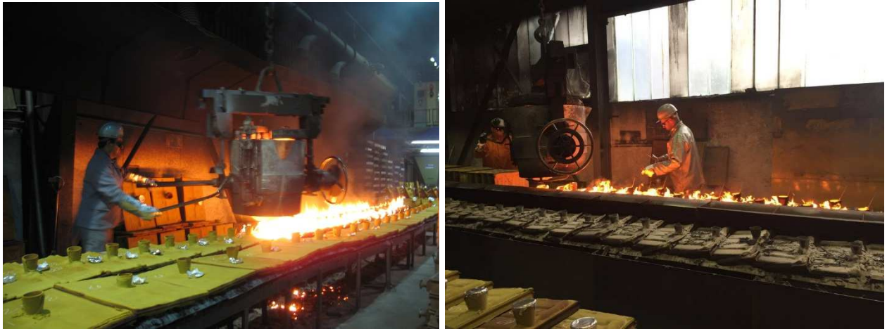
Abbildung 34: Staubentwicklung im Bereich der Croning-Anlage; linkes Bild: typische Anlage, rechtes Bild: Neuanlage
