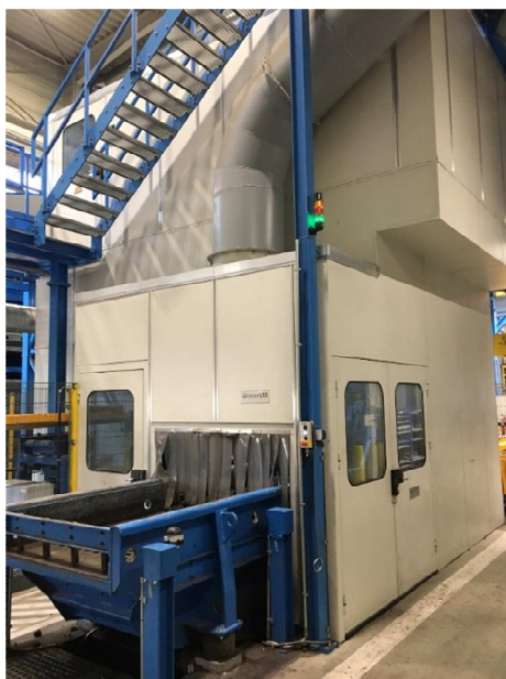
Abbildung 18: Lärmschutzkabine des Rüttelrostes (linkes Bild) sowie Blick auf den Rüttelrost durch eine geöffnete Tür der Schallschutzkabine
