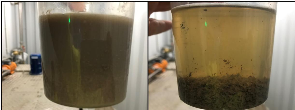
Abbildung 9: Waschwasser mit Schlamm vor und nach dem Flocken
