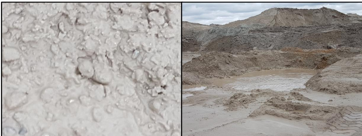
**Abbildung 6: Stark verunreinigtes Tunnelmaterial mit hohen Schlammanteilen**
