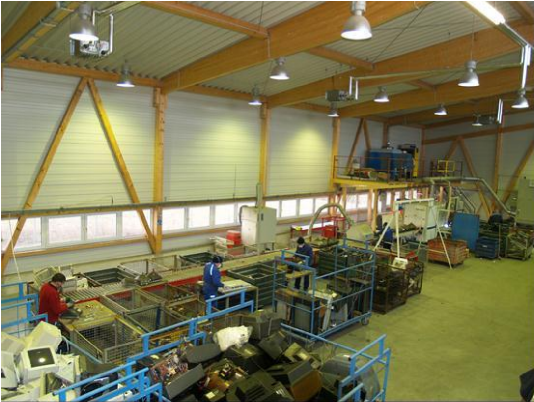
Abbildung 3: Bearbeitungs- und Aufbereitungslinie für Bildröhrengeräte mit Bildröhrenglas-Trennung mittels Lasertechnik
