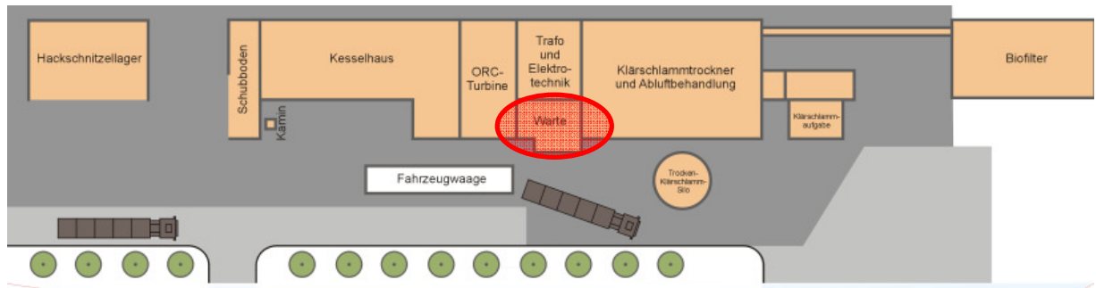
Abbildung 8 Zentrale Position der Warte auf der Anlage
