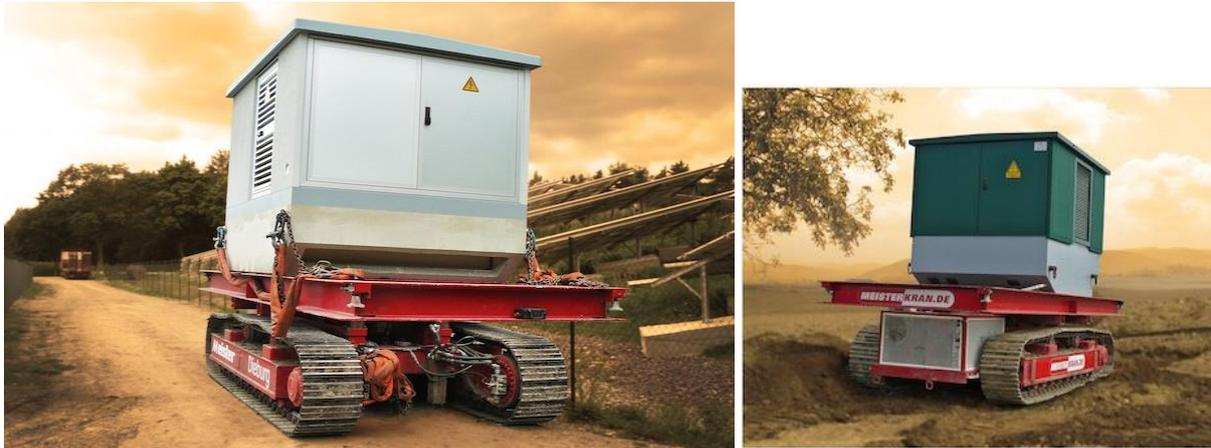
Abbildung 8: Transport eines Transformatorenhäuschens mit schwerem Transformator für Solaranwendungen auf unbefestigtem Gelände zu einem Solarfeld (links) und in einem Naturschutzgebiet (rechts).
