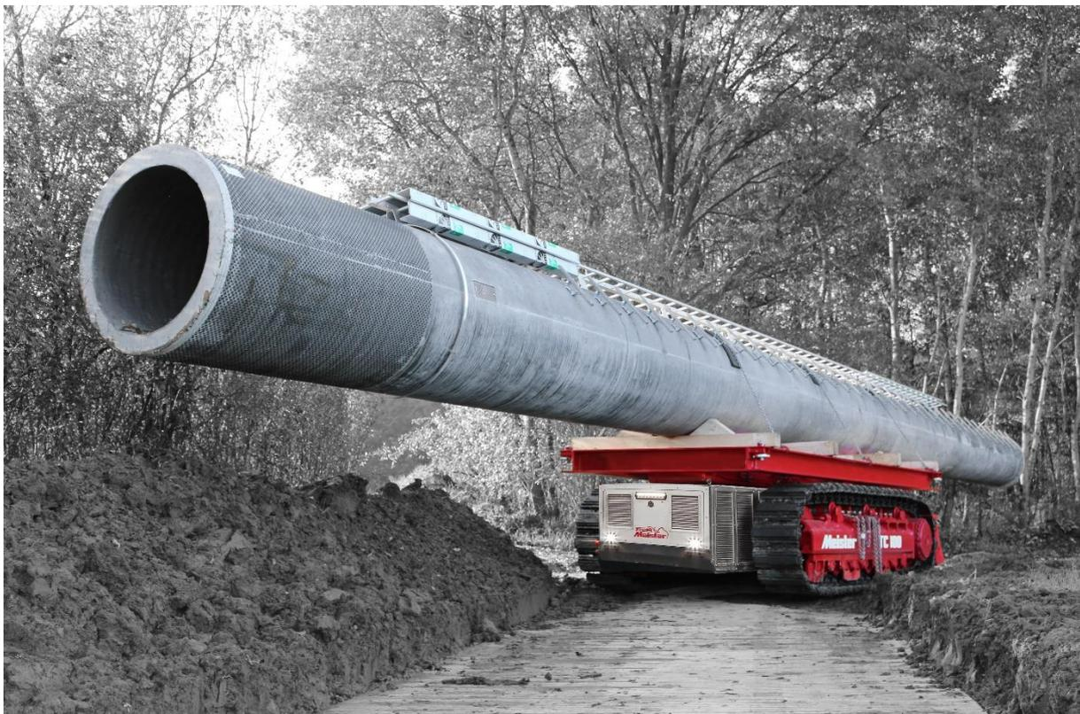
Abbildung 17: Transport eines Funkmastes im Betriebsmodus Direktladung
