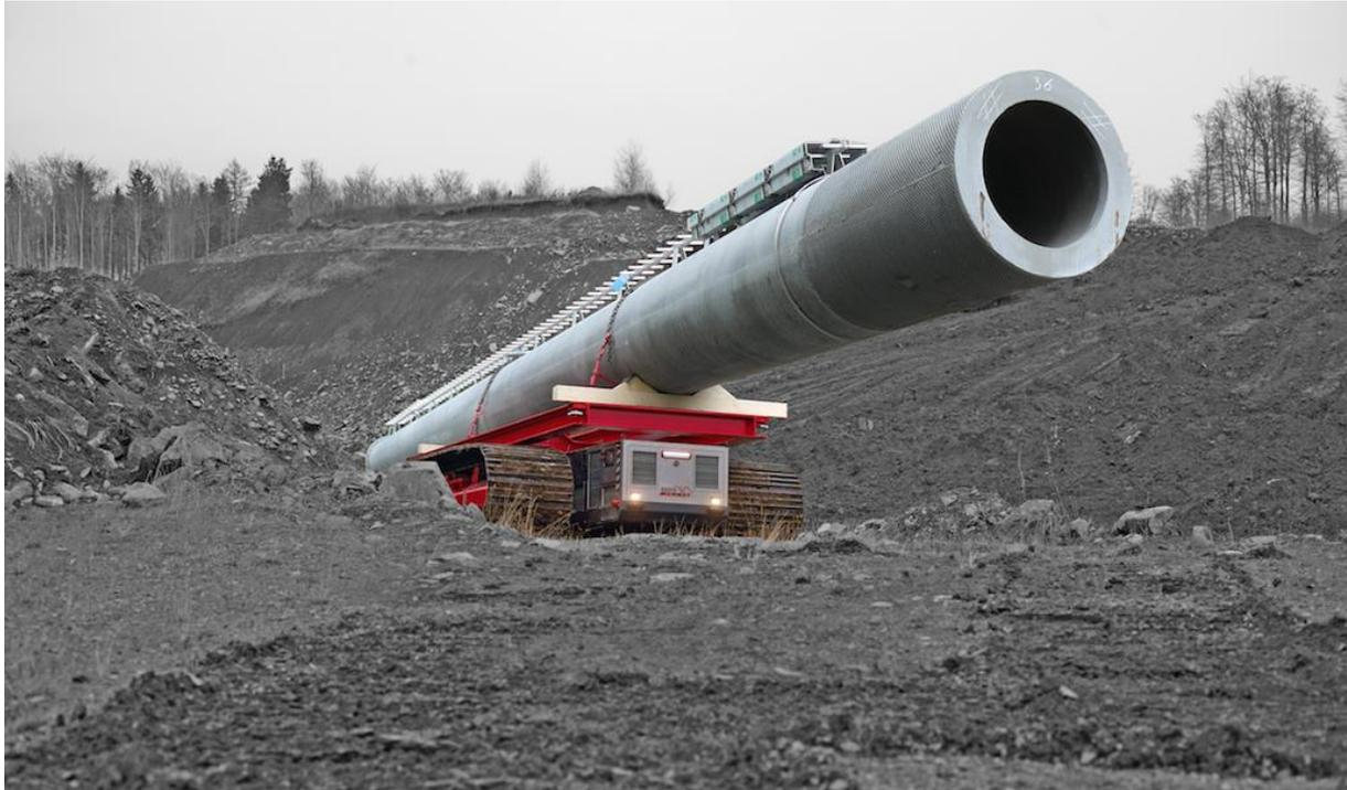
Abbildung 24: Dokumentation Testfahrten TC 100 mit 60 t Mobilfunkmast
