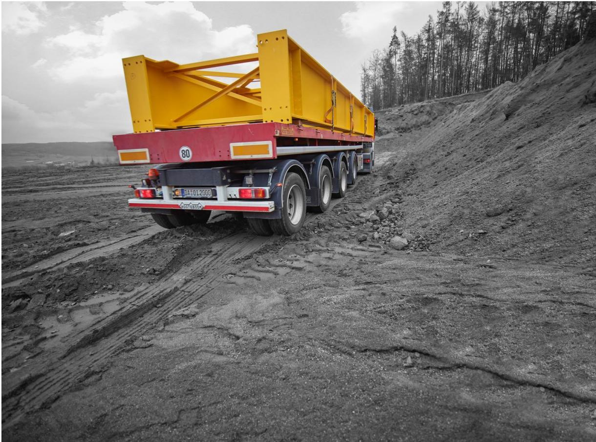
Abbildung 35: Transport des Pfeilers auf 3-Achs-Sattelzugmaschine mit 4-Achs-Sattelaufleger
