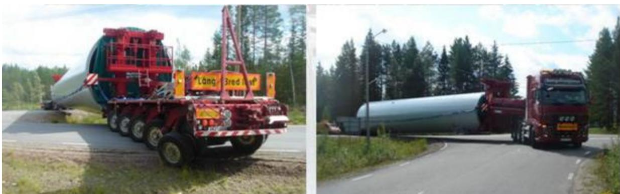
Abbildung 4: Transport einer Turmsektion (Quelle TII). Bei Steigungen in Anfahrt zu Standorten auf Anhöhen sind i.d.R. befestigte Wege erforderlich. Dazu kommen Eingriffe in die Natur durch Baumfällarbeiten, Wegeausbau und verbundener Bodenversiegelung. Das soll durch das „System-Meister“ weitgehend vermieden werden.
