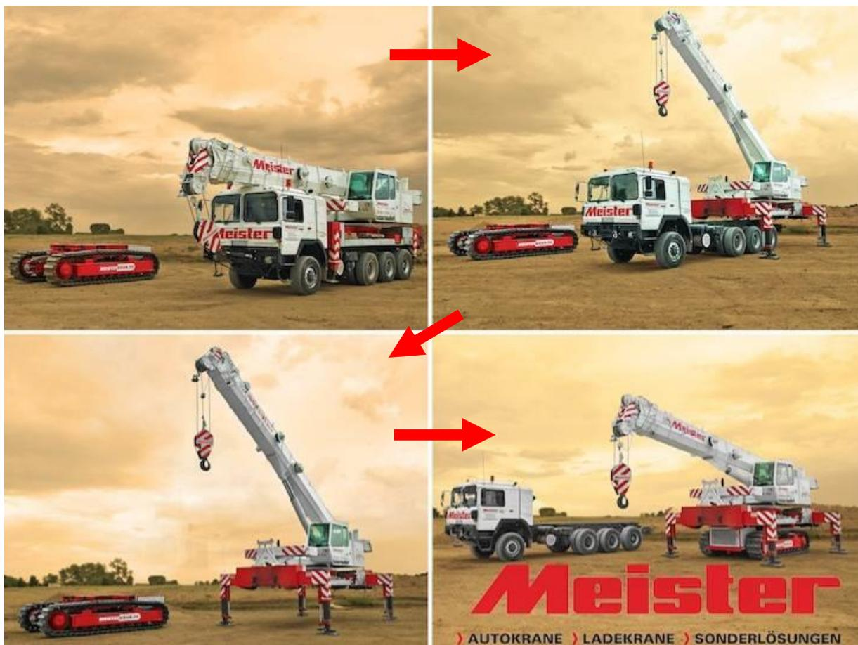
Abbildung 11: Wechseltage des Aufbaukrans auf Wechsellösungspritsche vom Lkw auf ein selbstfahrendes Raupenfahrzeug (rechts).
