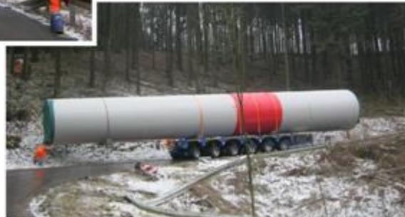
Abbildung 5: Transport einer Turmsektion mit Selbstläufer, aber Notwendigkeit einer befestigten Straße und Einschränkung in Steigung, Kippung und Kurvenradius (Quelle: TII).
