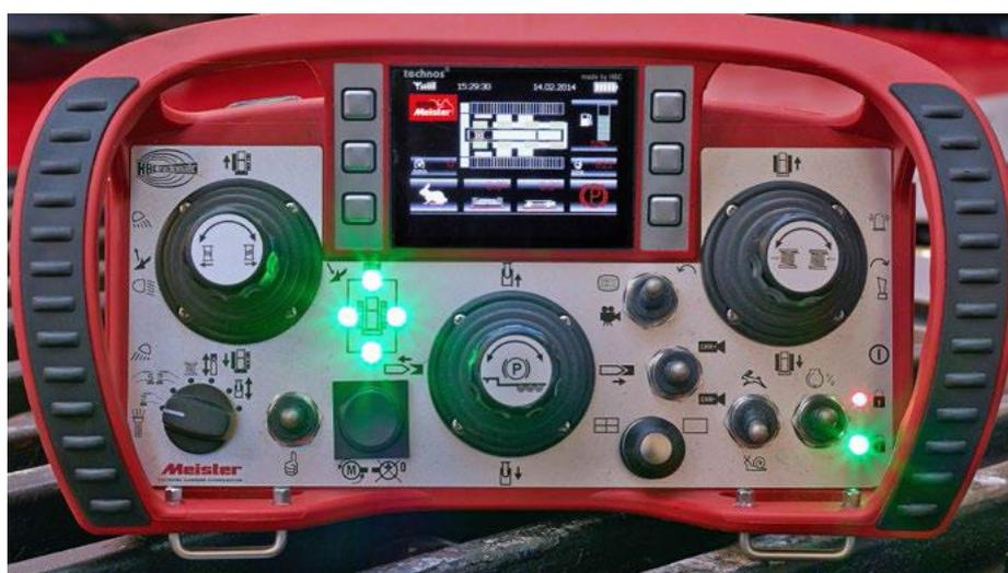
Abbildung 15: Funkfernsteuerung System-Meister TC 100 HBC Radiomatic.
