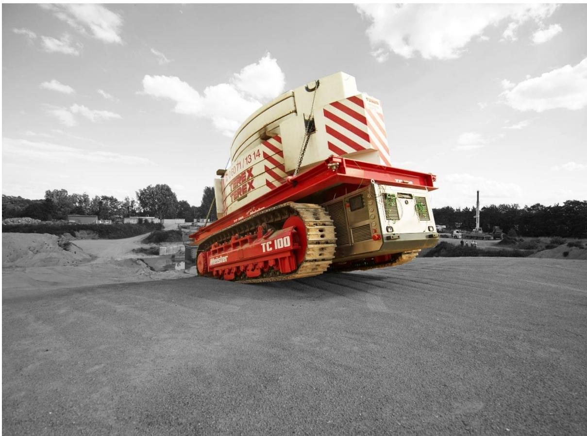
Abbildung 43: Testfahrten Feldversuch 100 Tonnen Zuladung
