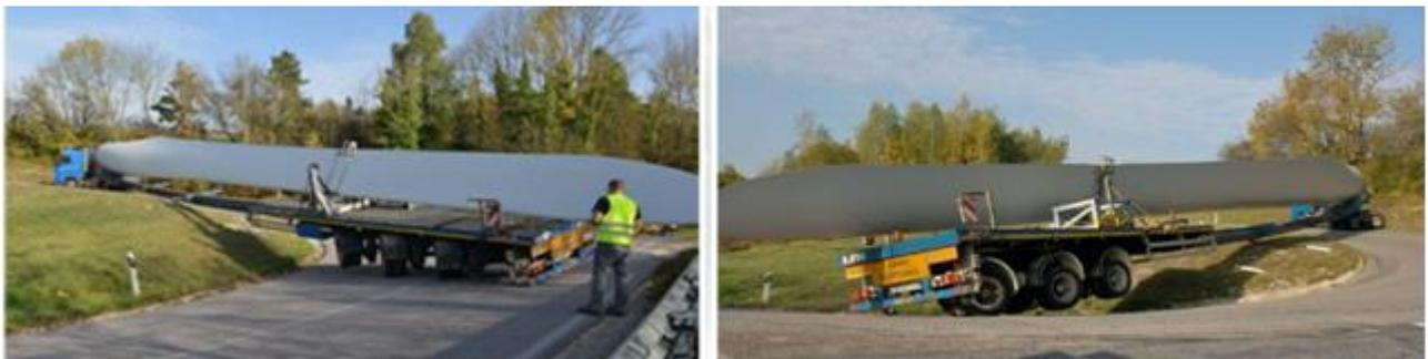
Abbildung 3: Transport eines Rotorblattes einer Windkraftanlage: Notwendigkeit einer Straße und freier Fläche, max. Blattlänge 40 m (Quelle: Transporter Industry International Sales (TII) )
