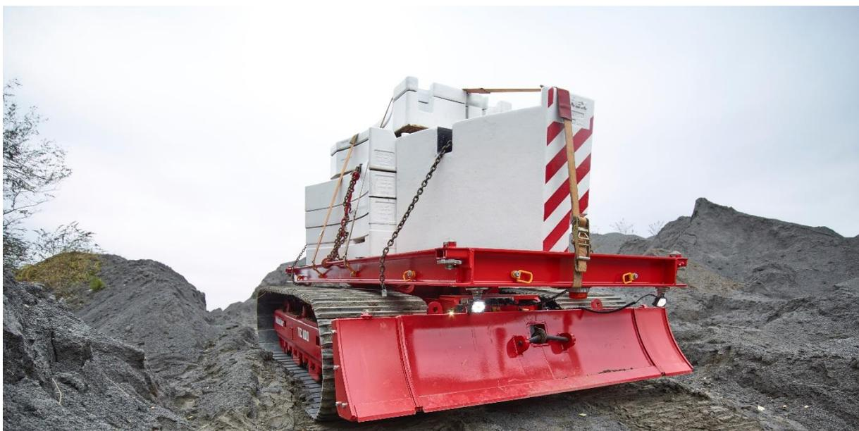
Abbildung 45: Einsatz des Räumschildes inklusive 25 Tonnen Bergewinde
