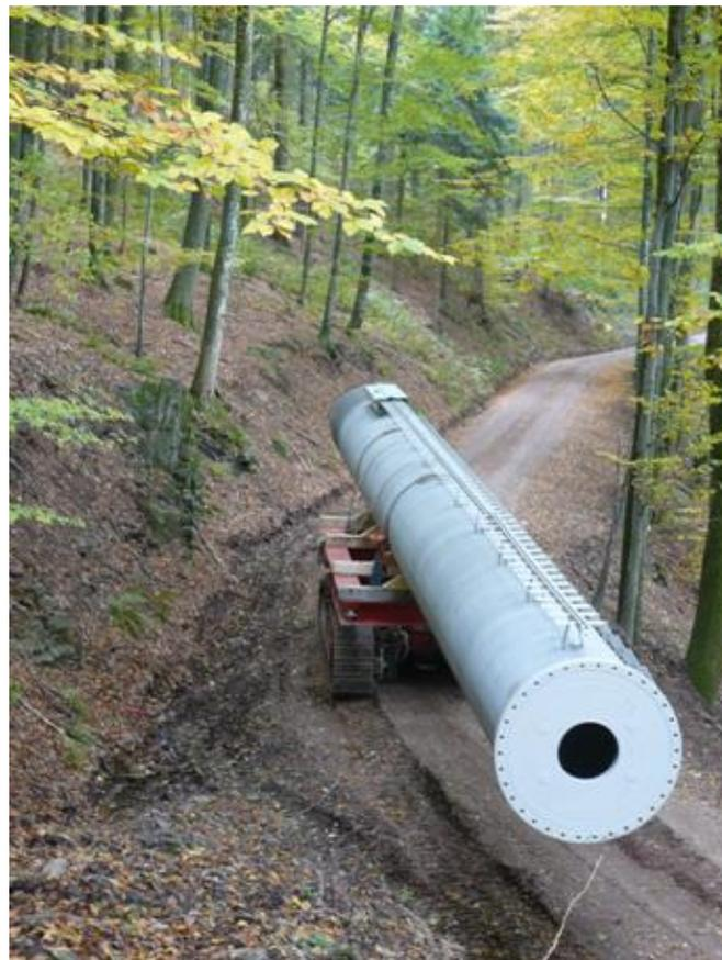
Abbildung 1: Transport eines langen und schweren Bauteils auf steilem, ungefertigtem Waldweg mit einem prototypischen Raupenfahrzeug als Kernstück des Systems-Meister TC 50 von Meisterkran (Quelle: Jochen Meister Meisterkran, Ergebnis ZIM-Projekt).
