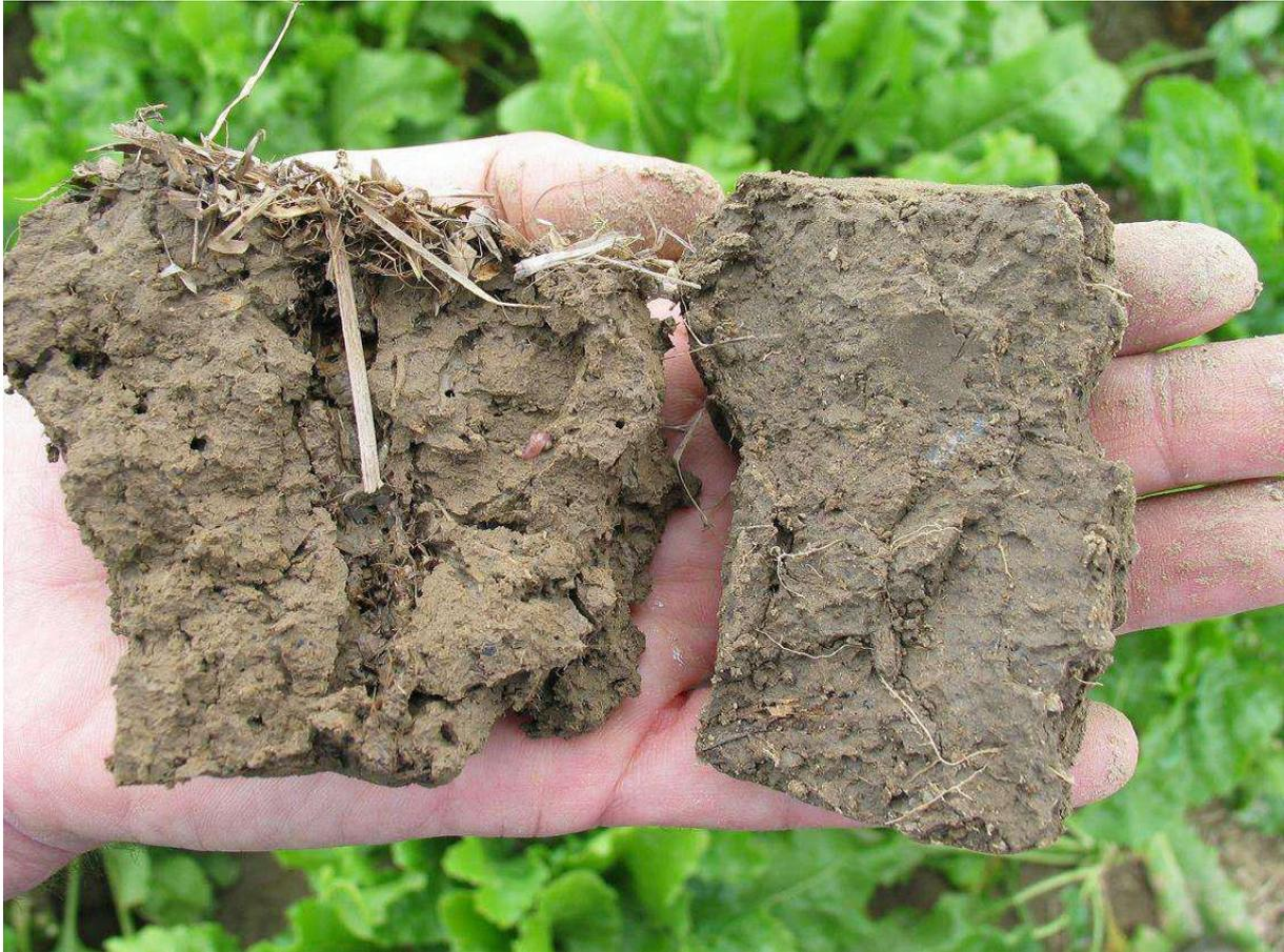
Abbildung 34: **Links:** unstrapazierter Boden – befahren mit Kettenfahrzeug (vergleichbar mit TC 100). **Rechts:** verdichteter Boden – befahren mit Schwerlastsattelzugmaschine und Sattelaufleger mit normaler Bereifung
