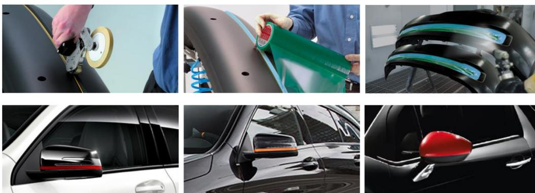
Abbildung 4: Beispielhafte Prozessschritte und Anwendungsbereiche der Maskierung
