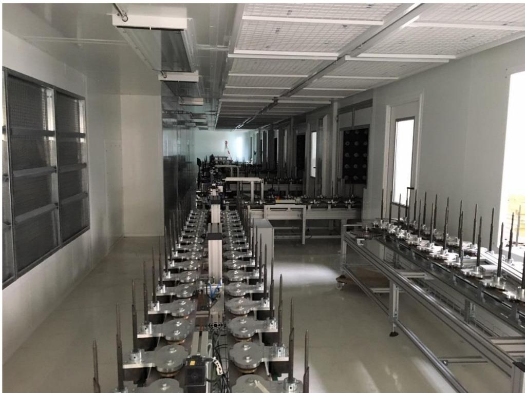
Abbildung 8: Dokumentation Anlagenaufbau, Fördersystem innerhalb der Lackierkabinen
