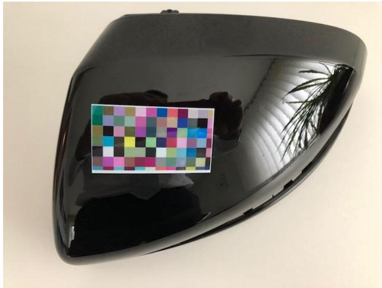
Abbildung 18: Außenspiegelgehäuse, maskierungsfreie Mehrfarbenlackierung mittels InkJet
