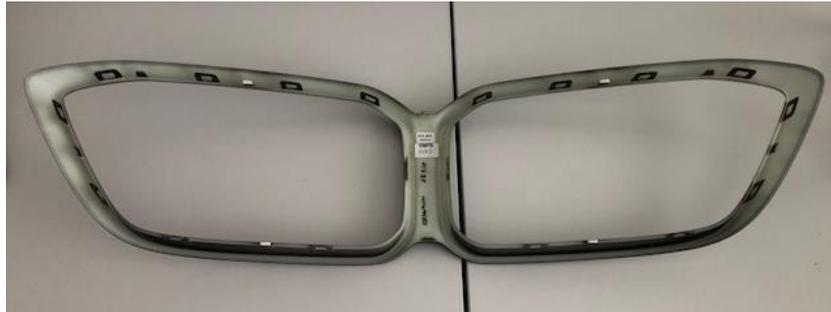
Abbildung 16: Rückansicht lackierte Kühlergrill-Niere
