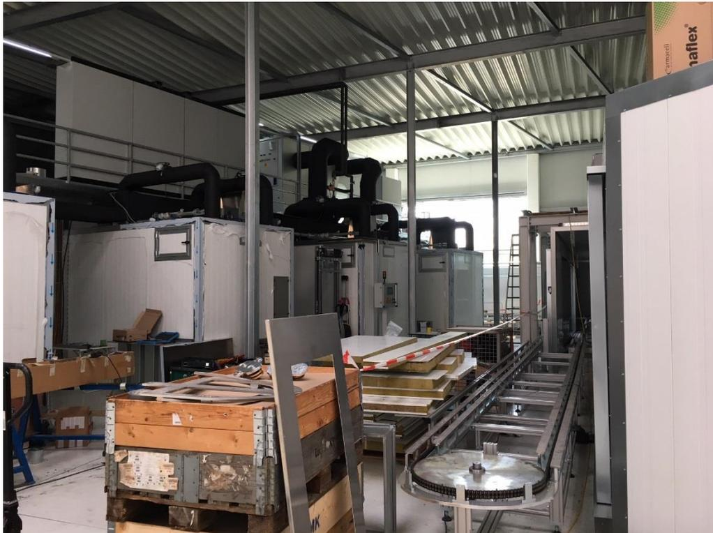
Abbildung 7: Dokumentation Anlagenaufbau, Fördersystem und Lackierkabinen
