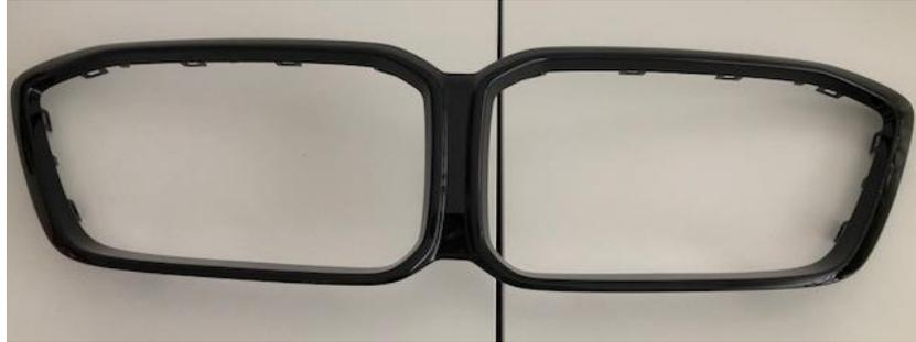
Abbildung 15: Vorderansicht lackierte Kühlergrill-Niere
