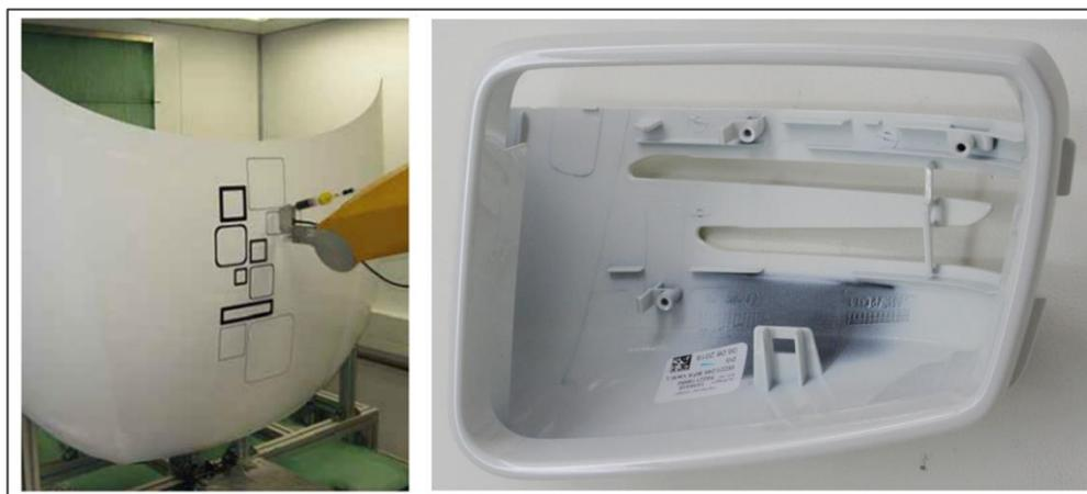
**Abbildung 6: Vergleich Mikrodosierung über Piezoelemente und Stand der Technik
