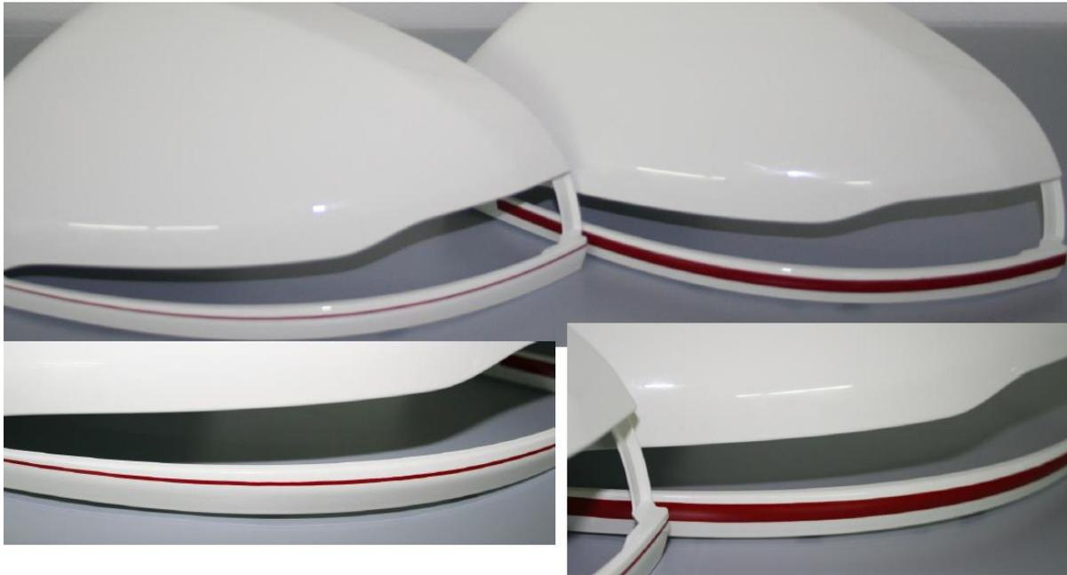
**Abbildung 19: Außenspiegelgehäuse, maskierungsfreie Mehrfarbenlackierung mittels Piezo-Technologie**
