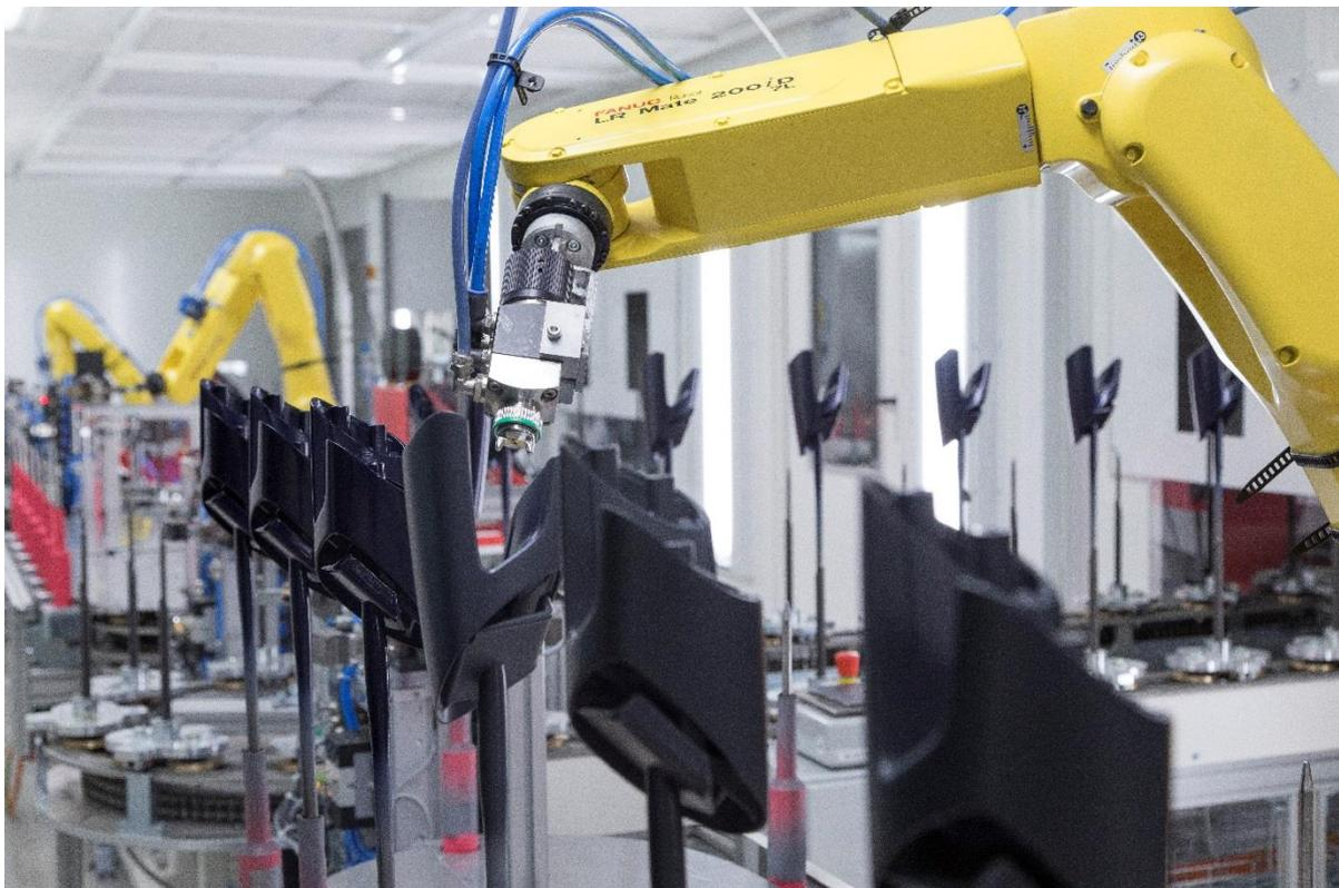
Abbildung 11: Dokumentation Anlagenbetrieb, koturnahe Lackierung zur Oversprayreduzierung
