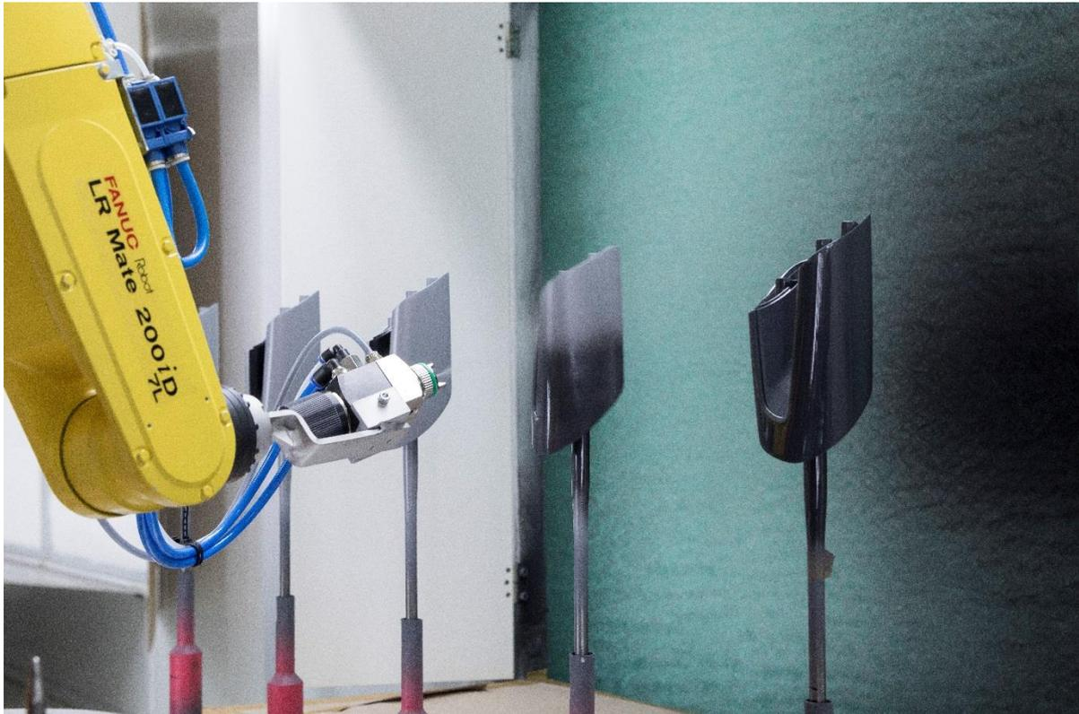
Abbildung 12: Dokumentation Anlagenbetrieb, Detailaufnahme oversprayarme Lackierung V-Fuß
