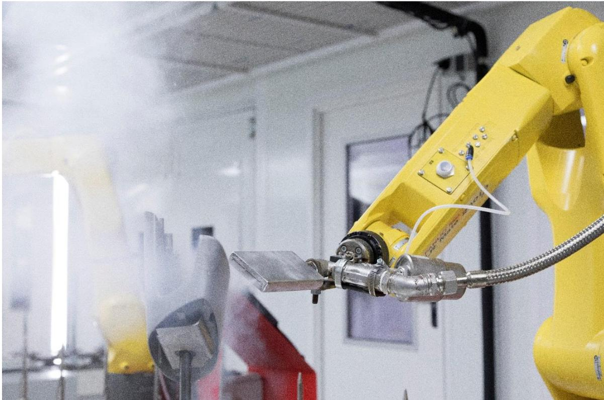
Abbildung 14: Dokumentation Anlagenbetrieb, Einsatz der Dampfdüse zur Bauteilreinigung
