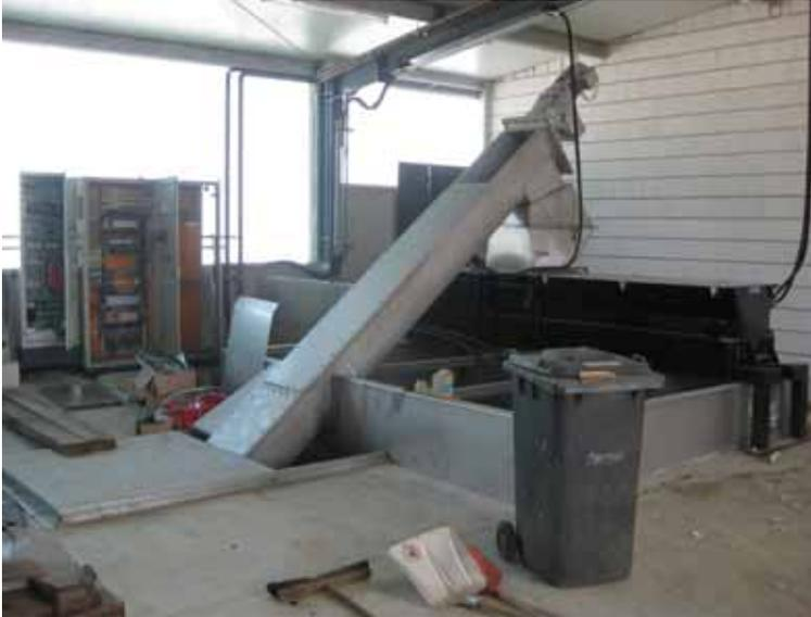
Bild 15: Förderschnecke aus Anmischbehälter zur Röhrenpresstechnik
