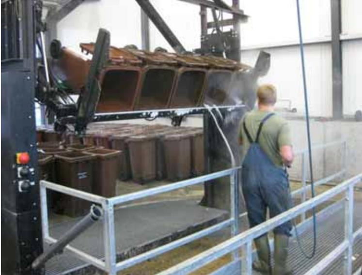
Bild 2: Waschvorgang der Tonnen über dem Auffangbehälter
