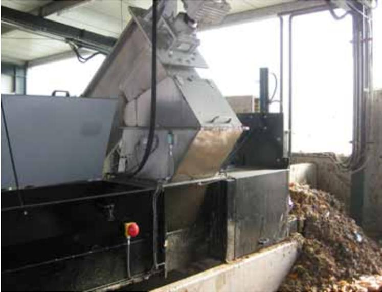
Bild 4: Röhrenpresse mit Förderschnecke zur Beschickung
