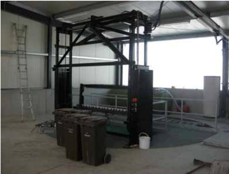
Bild 14: Abkippeinrichtung für Tonnen in Anmischbehälter
