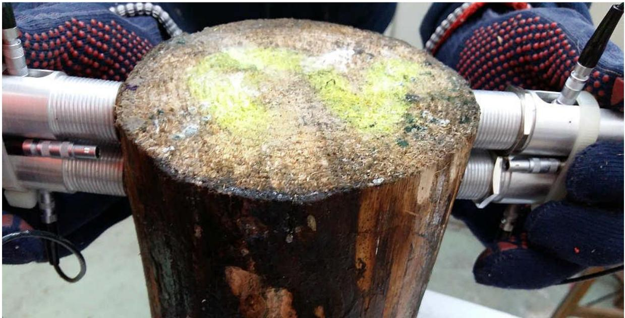
*Abbildung 17 - Ultraschalluntersuchung eines Teststammes.*
