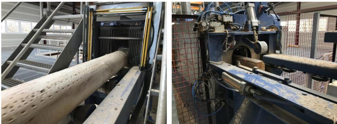
*Abbildung 10 - Einzug in (links), Auszug aus der Profiliermaschine (rechts).*
