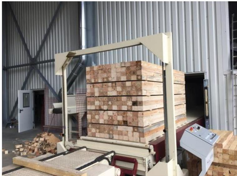
*Abbildung 13 - Ausgabe Schnittholzpakete mit Umreifungsvorrichtung.*
