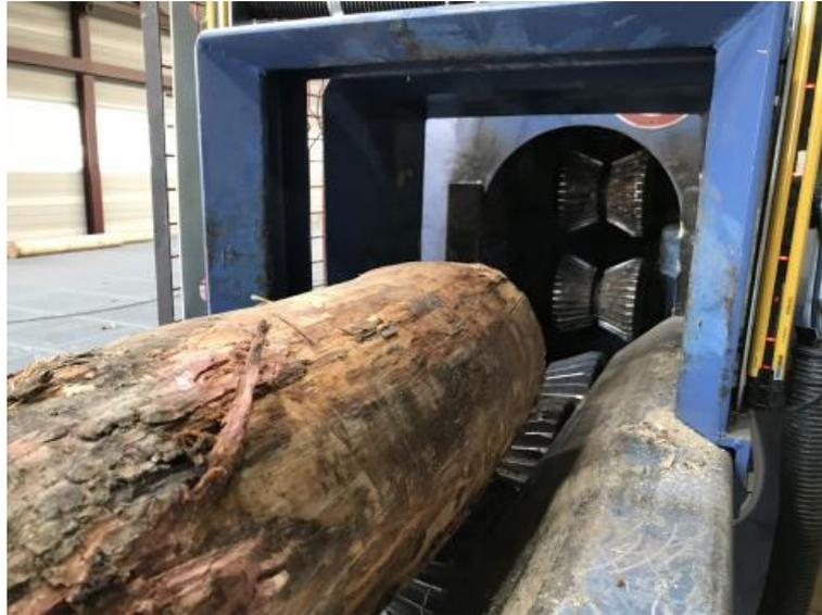
*Abbildung 9 - Einzug zur Rundstabfräse.*
