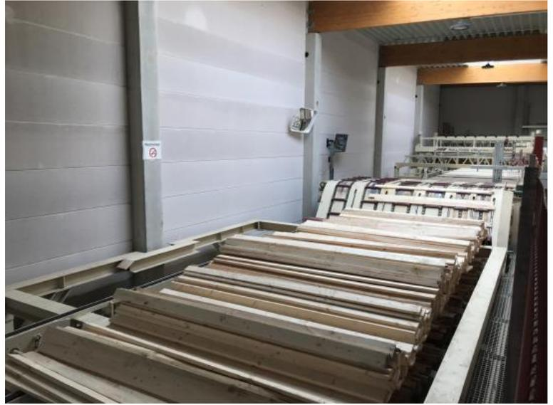
*Abbildung 12 - Sortierstrang zur KALLFASS Stapelanlage.*
