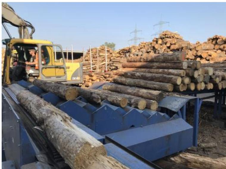
*Abbildung 8 - Stufenförderer und Querförderer für die Zuleitung zur Sägelinie.*
