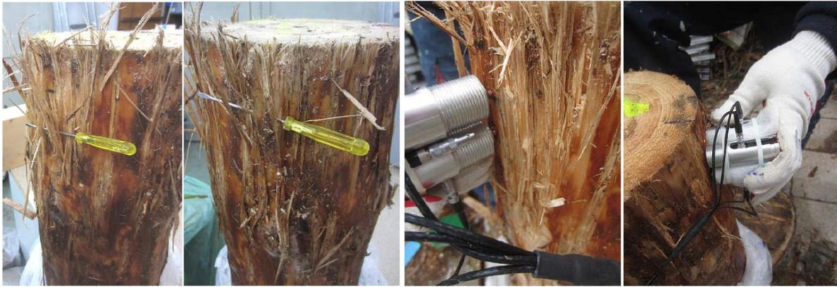
Abbildung 22 – Stark ausgefranztes Rundholz während der Ultraschallprüfung.
