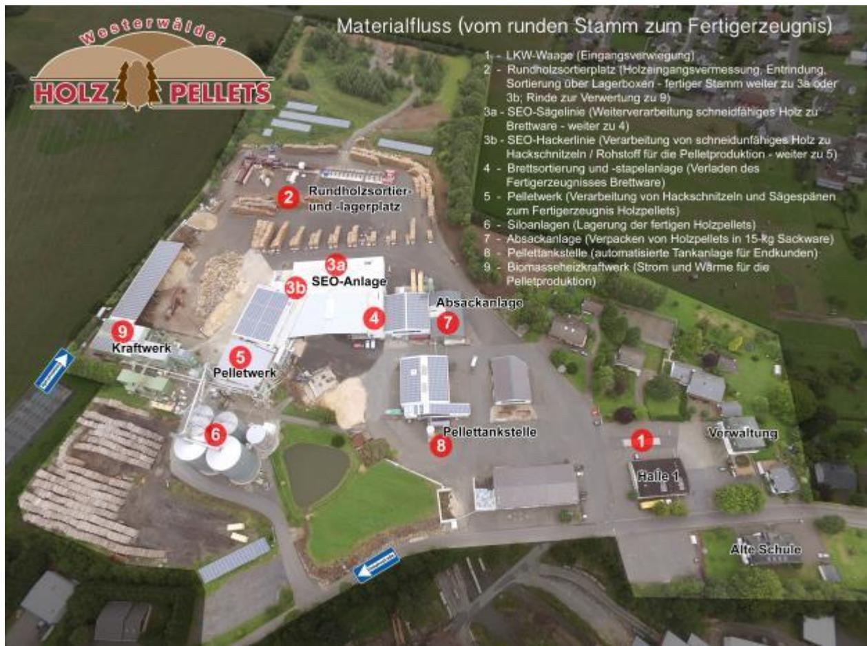
Abbildung 15 - Dimension der Prozesskette aus der Vogelperspektive (vom runden Stamm zum Fertigerzeugnis).
