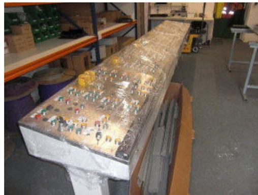
Abbildung 4: Fertiggestellte Bedienpulte für den Steuerstand der Stranggießanlage
