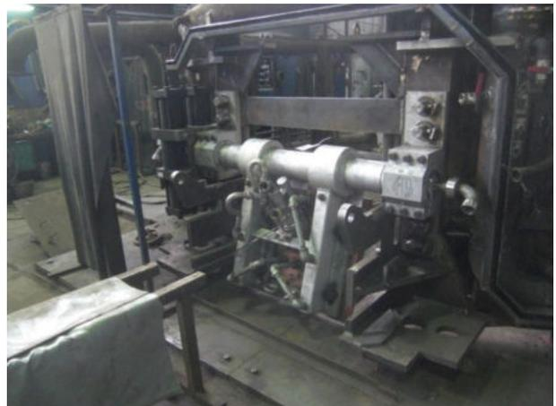
Abbildung 37: Blick auf das äußere Gefäßoberteil des Elektro-Lichtbogenofens (EAF); Linke Abb.: Schlackentüre vor dem Umbau; Rechte Abb.: Neue Schlackentüre mit komplexer Ansteuerung
