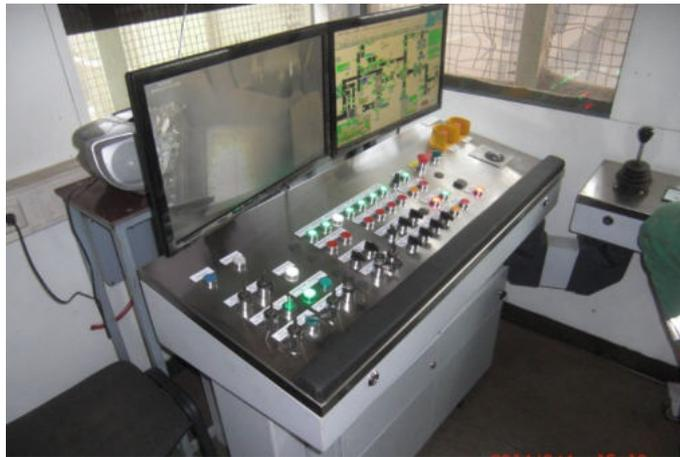
Abbildung 32: Neue Bedien- und Visualisierungstechnik an der Shredderanlage
