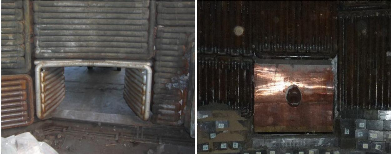
Abbildung 38: Blick in das innere Gefäßoberteil des Elektro-Lichtbogenofens (EAF) mit Kühlsystem und Schlackenausgang Linke Abb.: vor dem Umbau Rechte Abb.: nach dem Umbau
