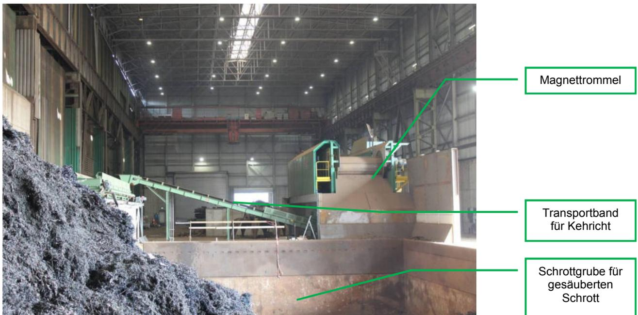
Abbildung 36: Magnettrommelanlage nach dem erfolgten Aufbau im April 2015
