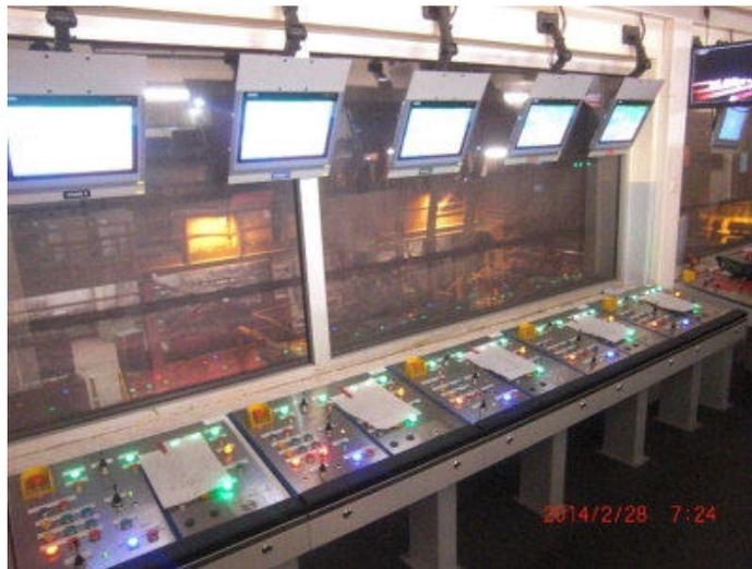
Abbildung 5: Steuerstand der Stranggießanlage nach dem Umbau mit neuen Bedienpulten.
