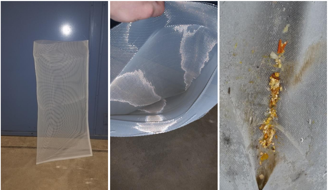
Abbildung 26: Filtrationssack mit 1,0 mm Maschengeometrie
