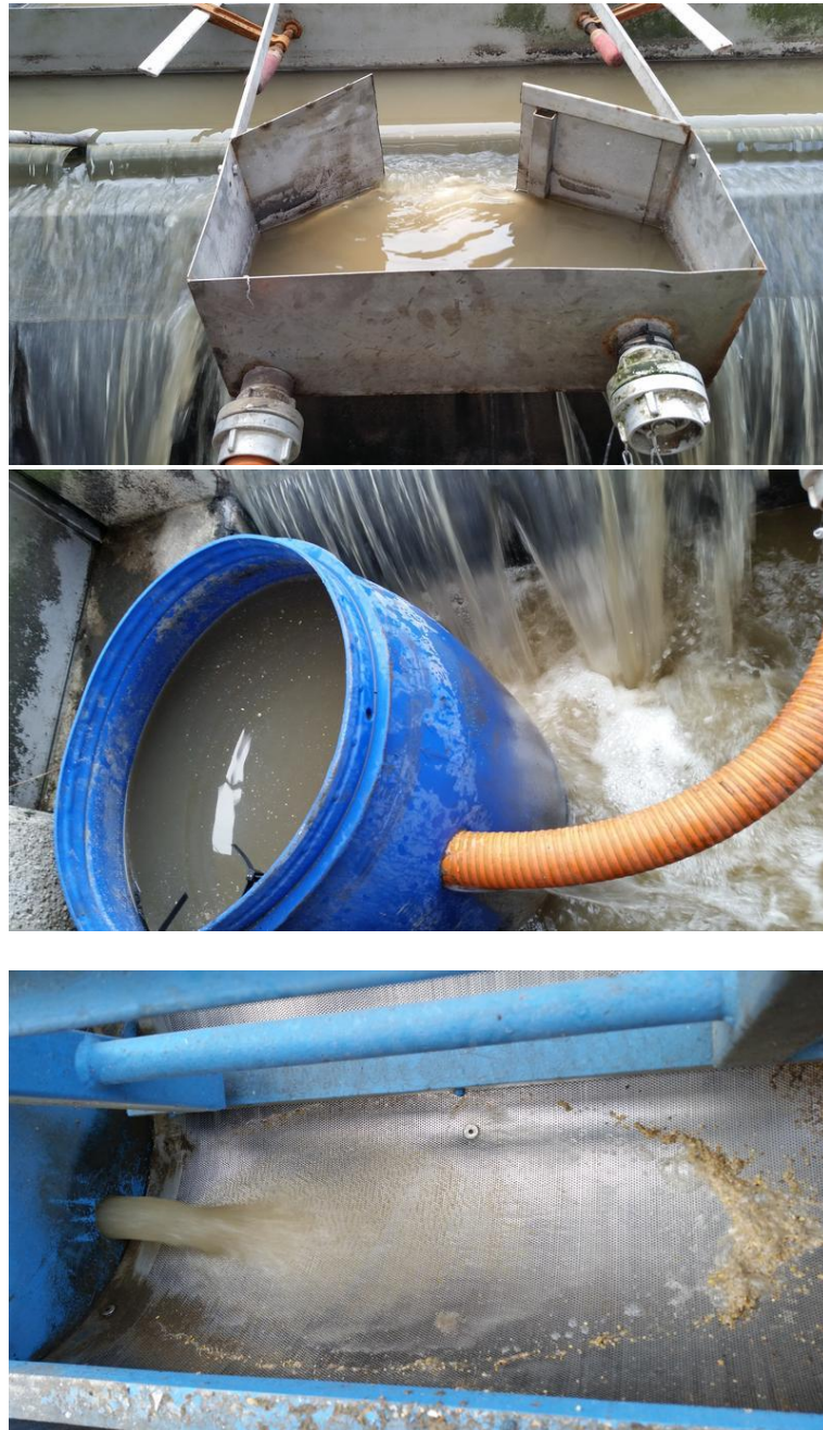
Abbildung 10: Beschickung des Muldensiebes
