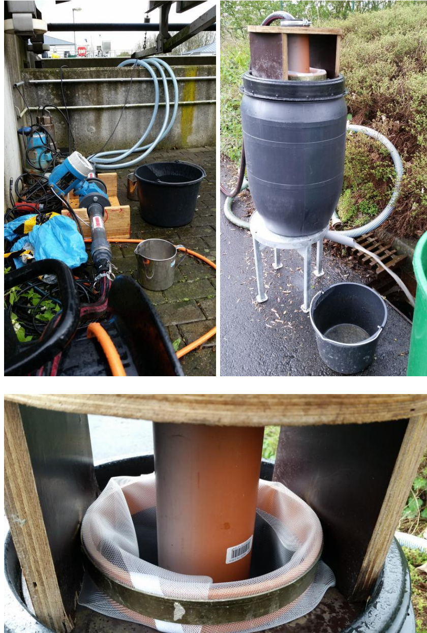
Abbildung 27: kontinuierlicher Probenahmebetrieb mit Filtrationssock
