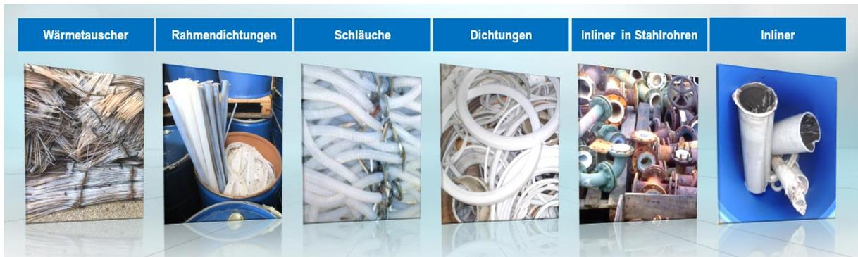
Abbildung 22: Beispiele für EoL-Fluorpolymerabfälle aus PTFE, die derzeit in der Demonstrationsanlage recycelt werden.
