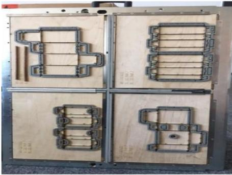
Abbildung 6: Schließrahmen zum Aufnehmen von 4 Werkzeugen
