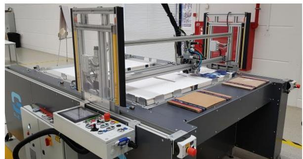
Abbildung 11: Halbautomatische Klebelinie
