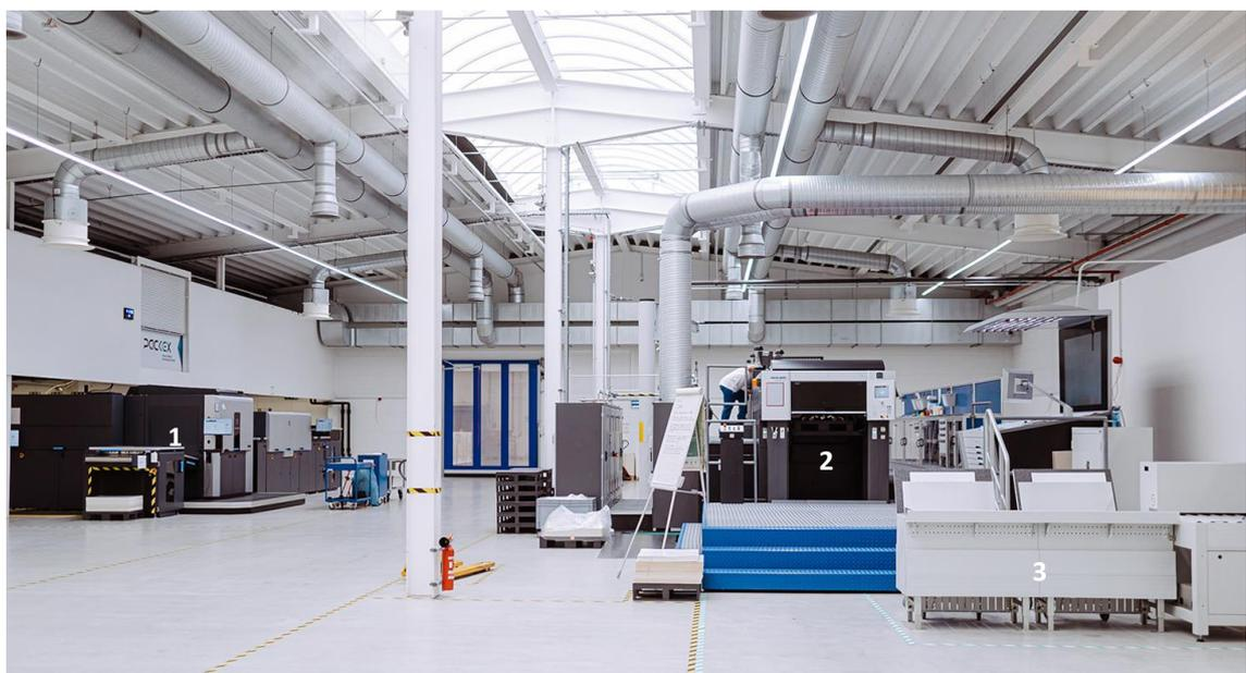
Abbildung 3: Digitaldruckmaschine (1) und Offsetdruckmaschine (2) beide mit 7 Druckfarben sowie Ablage der automatisierten Plattenstraße (3)
