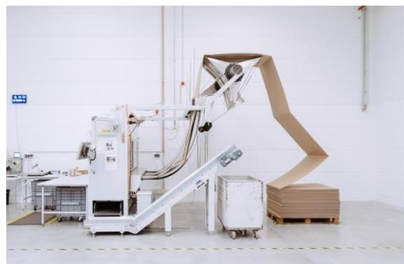
Abbildung 12: Packsize-Maschine zur maßgenauen Herstellung der Wellpapp-Umverpackung
