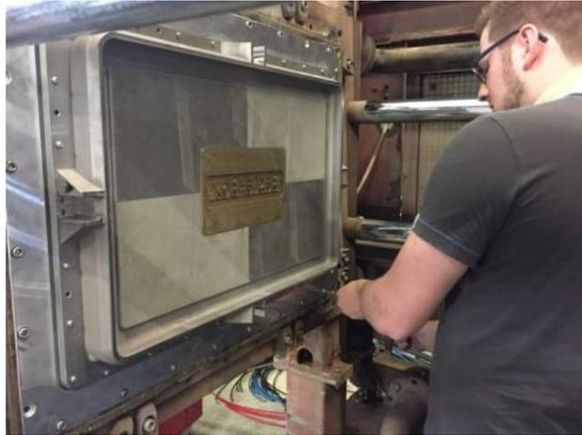
Abbildung 20: Einspannen der Kavität „Basta Box Deckel XL“ in den Formschaumautomaten
