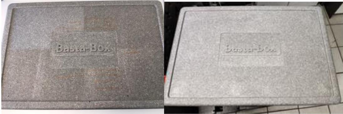
Abbildung 24: Basta-Box Deckel optische Probleme mit Schattenwurf links und neu ohne rechts
