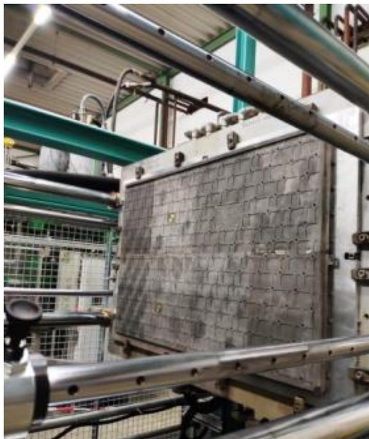
Abbildung 33: Kern der Kavität „TerraEPP“ eingespannt in neuen Formschaumautomaten
