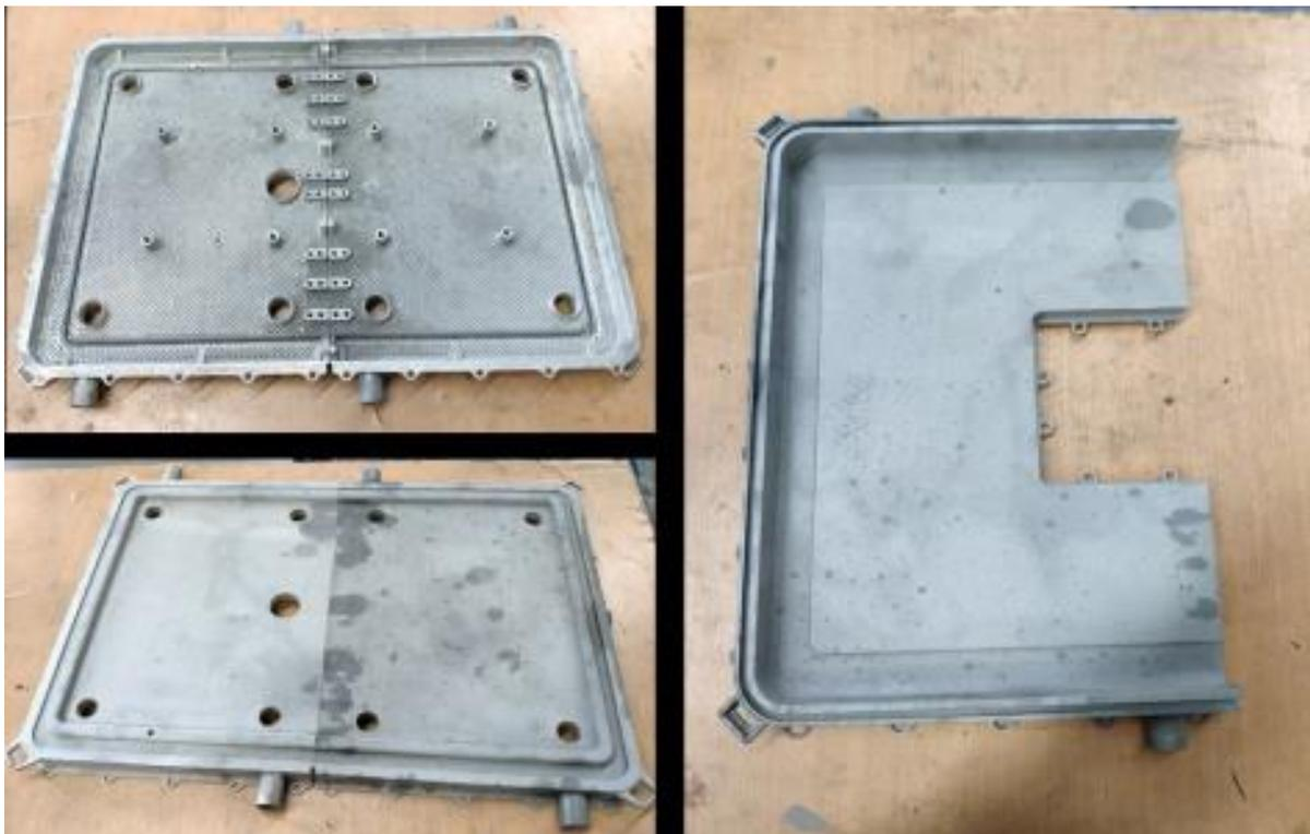
Abbildung 25: „Basta Box Deckel XL V3“ gedruckte Kavität: Kern Segmente von hinten (o.l.) und von vorne (u.l.) und Haube Segment von vorne (rechts)
