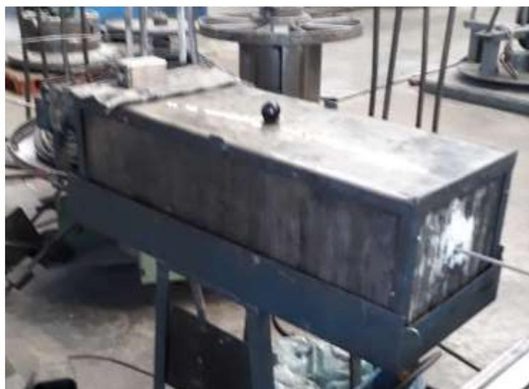
Bild 4: Ziehsteinkasten mit Ziehstein und Ziehmittel
