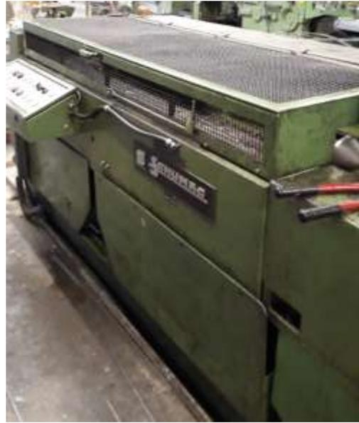
Bild 6: Stangenziehbank
