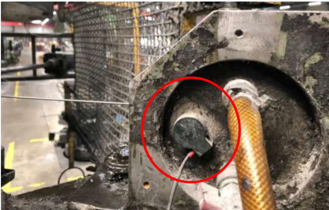
Bild 15: eingebauter HFIM-Sensor am Vorzug der dualen Enden-Bearbeitung
