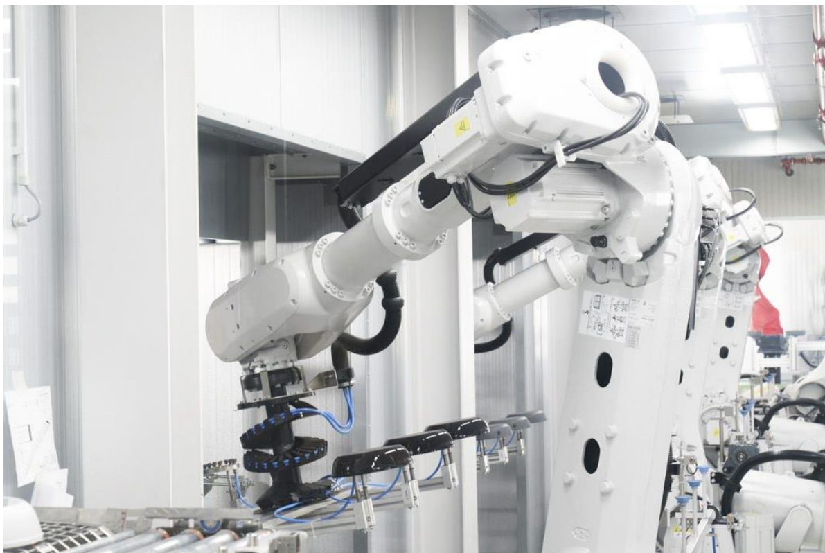
Abbildung 12: Serienbetrieb – einlegen der außen mit wasserbasiertem Lack beschichteten Pfannen in den Trockenofen
