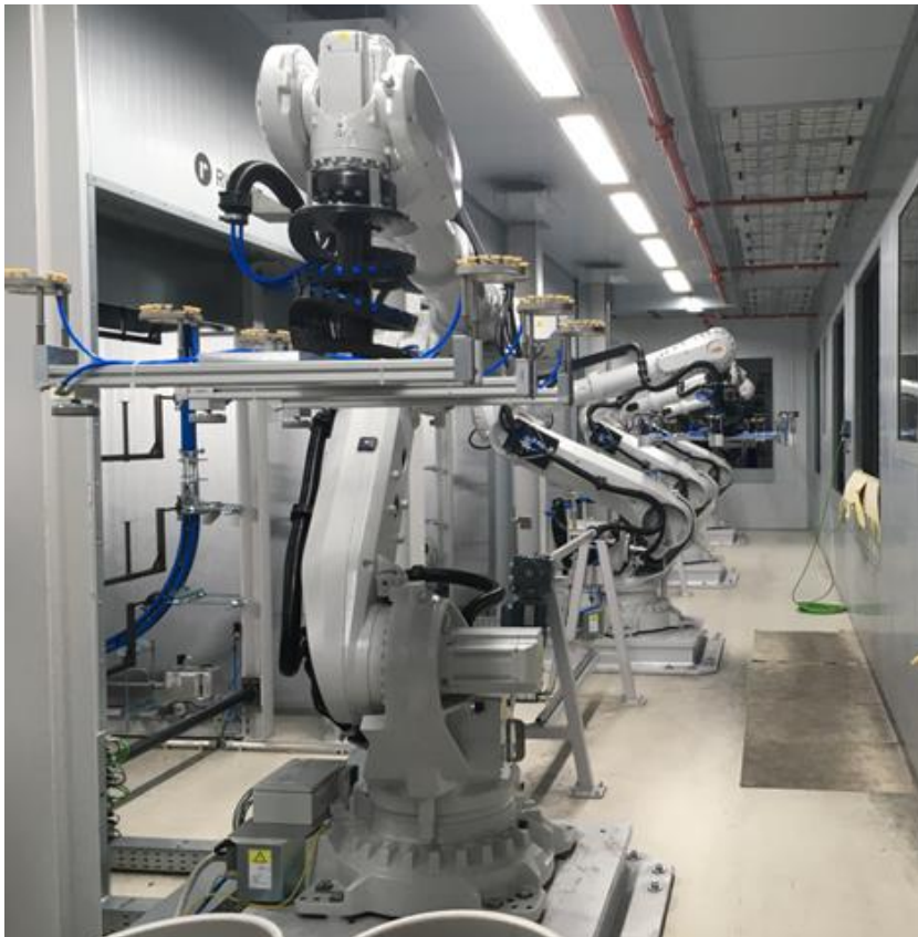
Abbildung 5: Ansicht Handlings- und Transfereinheit
