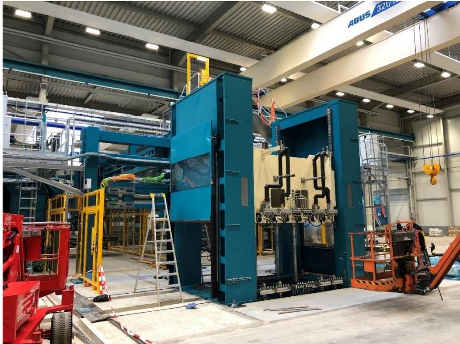
**Abbildung 13: Aufbau der Presse bei GEDIA**
