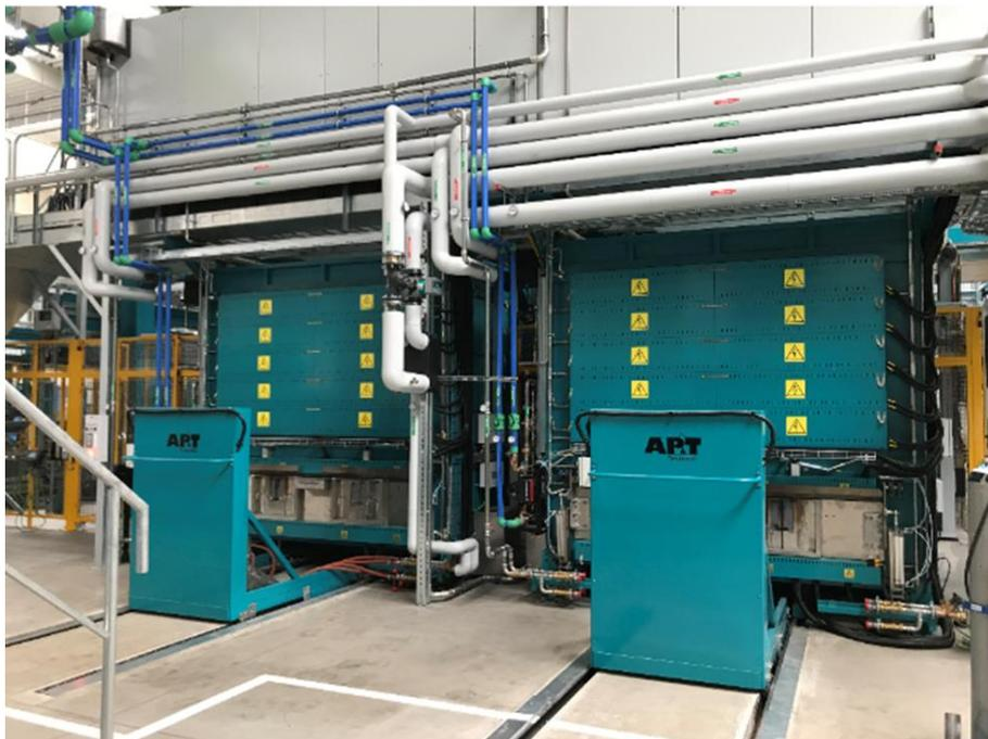
Abbildung 16: Rückseite der Öfen 2 und 4 inklusive TemperBox® und Rüstvorgang
