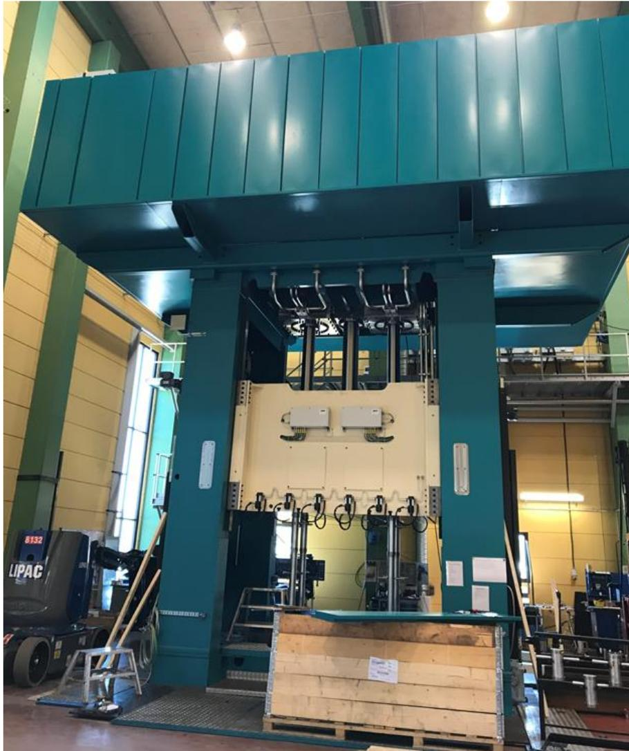
Abbildung 12: Aufbau und Erprobung der servohydraulischen Presse beim Lieferanten
