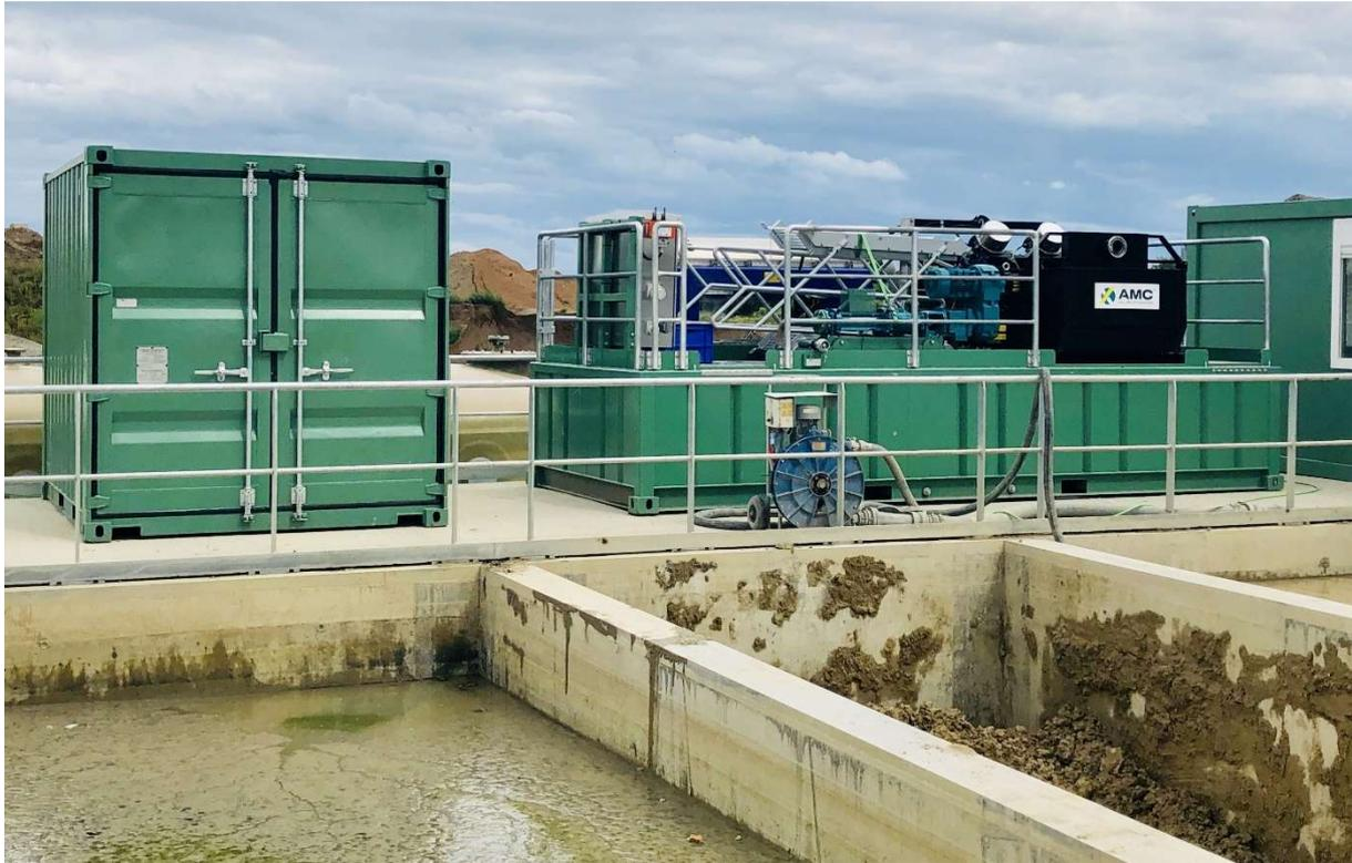
**Abbildung 6: Flockstation, Zentrifuge und Shaker**
