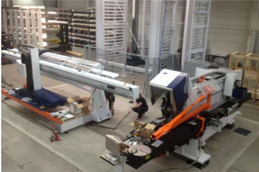
Abbildung 2.24: Installation der Stanzanlage TruPunch 5000
