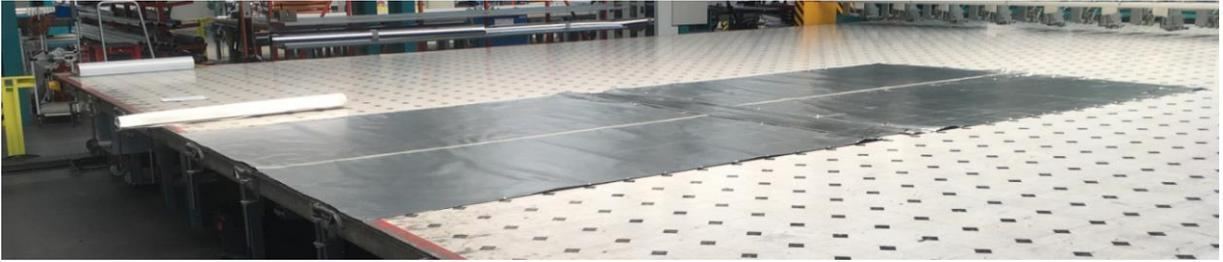
Abbildung 2.10: Layermontagestation mit liegenden Layern
