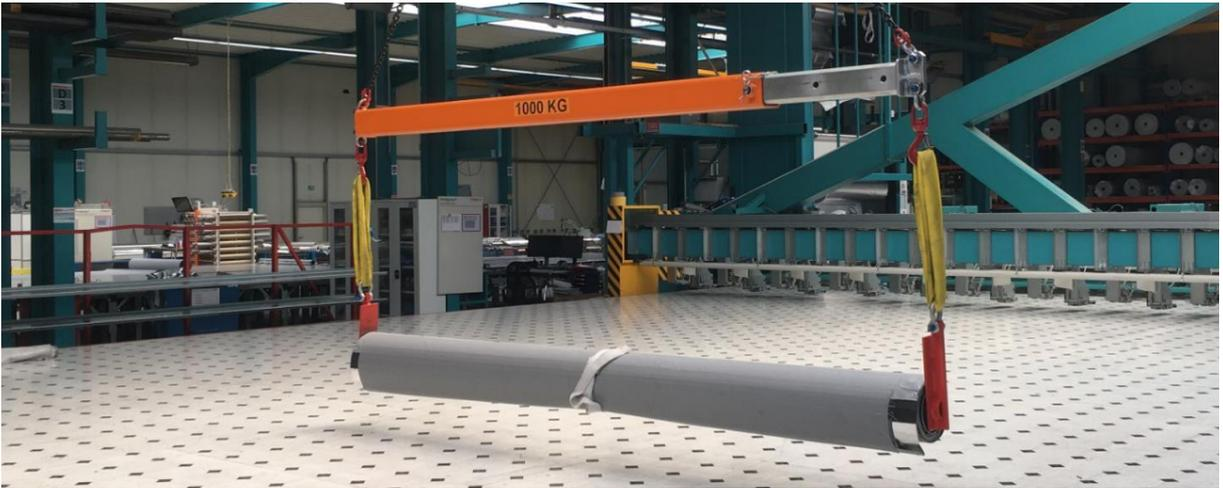
Abbildung 2.11: Layermontagestation, Transport fertiger Wickelwelle mit Gewebe
