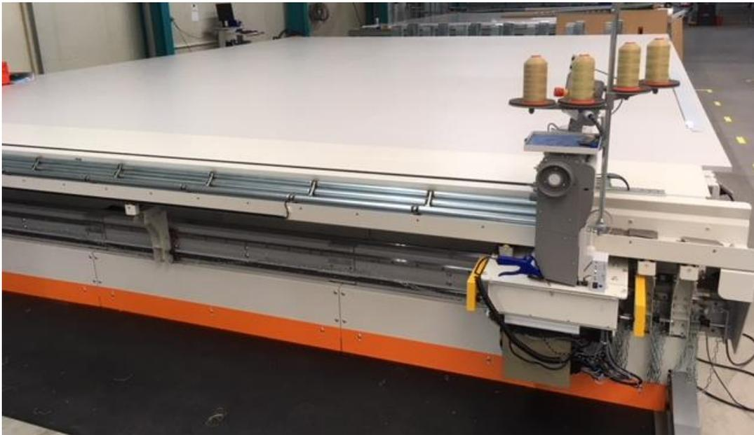
Abbildung 2.6: Nähanlage Sewsy Spezial 868 (5m) mit Luftkissentisch
