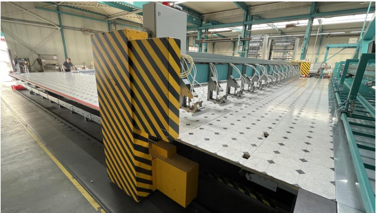
Abbildung 2.9: Blick auf den Layermontagetisch und die Greiferbrücke.
