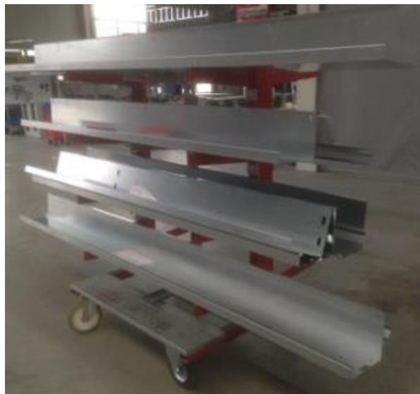
Abbildung 2.21: Stahlblechprofile des Biegezentrum
