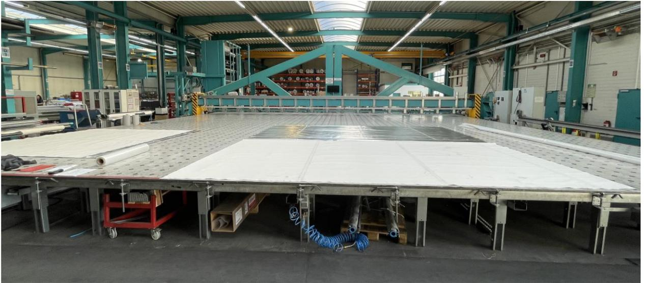
Abbildung 2.8: Blick auf den Layermontagetisch und die Greiferbrücke Totale
