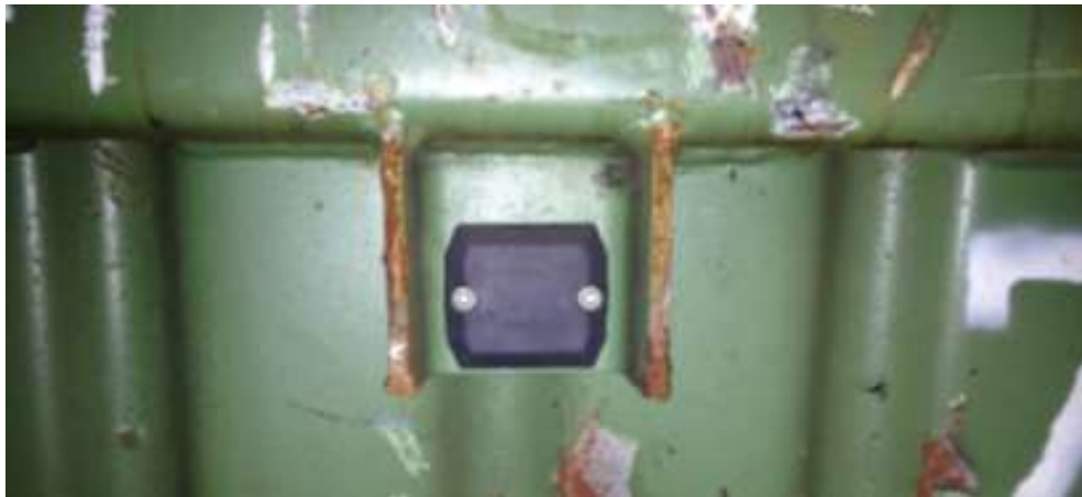
Abbildung 12: RFID-Tag am Metallkübel für die Identifikation im Transportsystem
