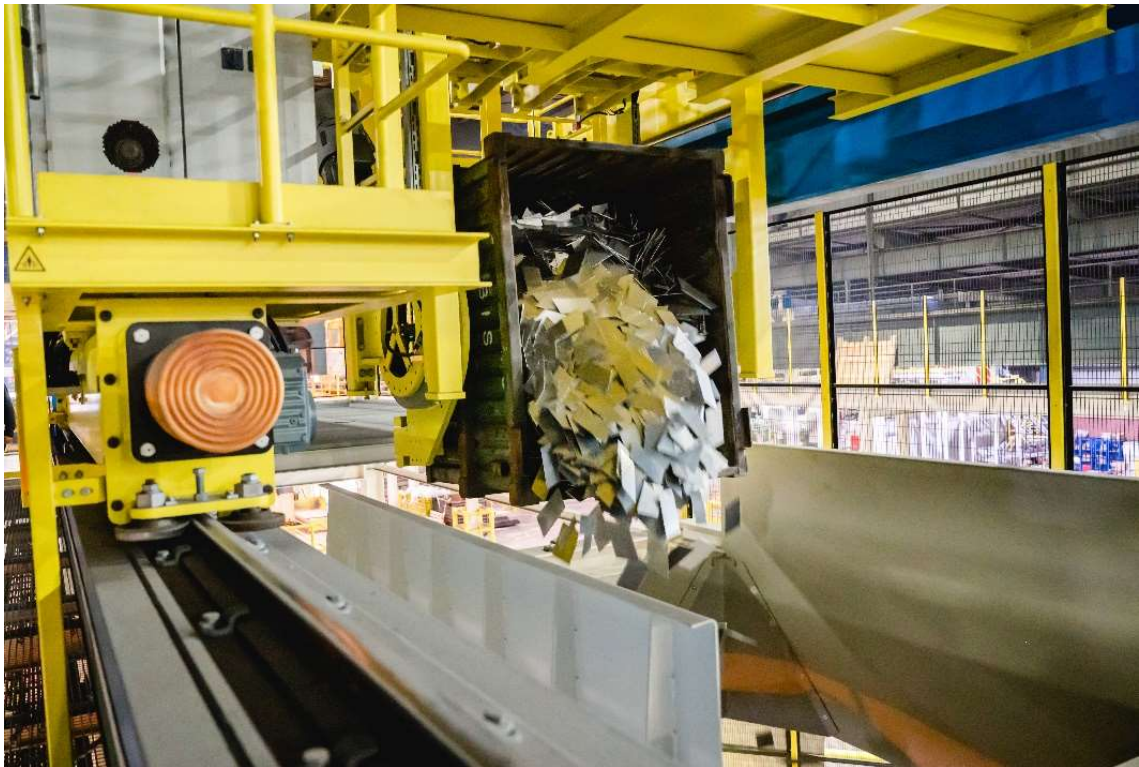
Abbildung 21: Kippmanipulator: entleert die Kreislaufschrötte in den Chargierkorb
