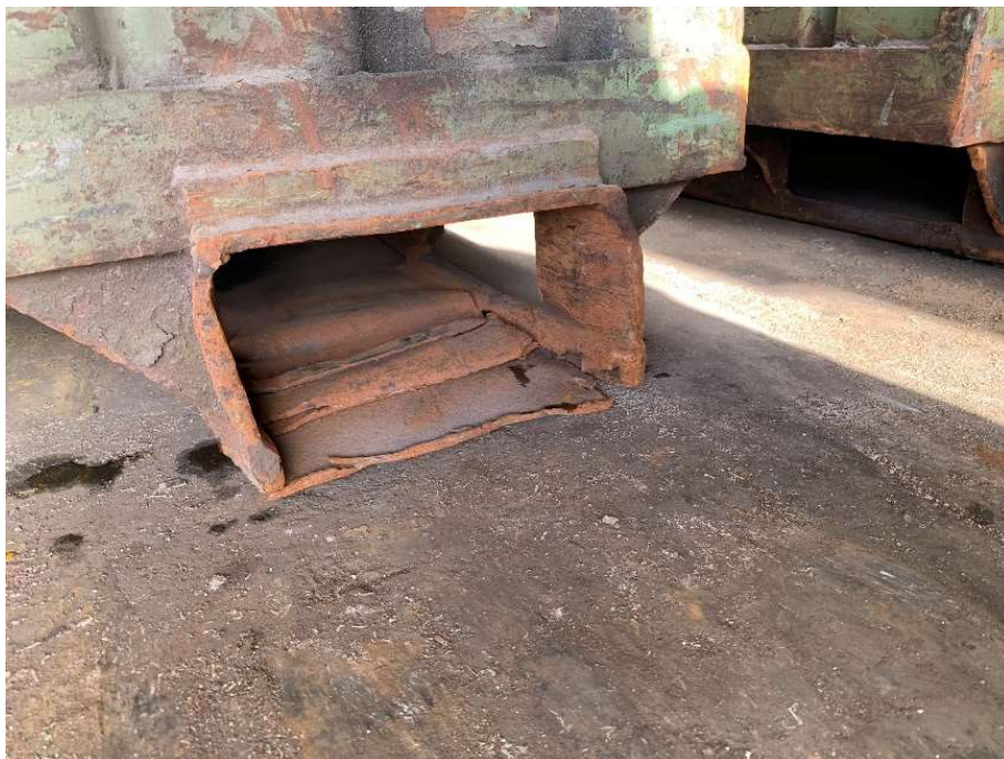
Abbildung 10: nicht transportfähige Kübel müssen repariert werden
